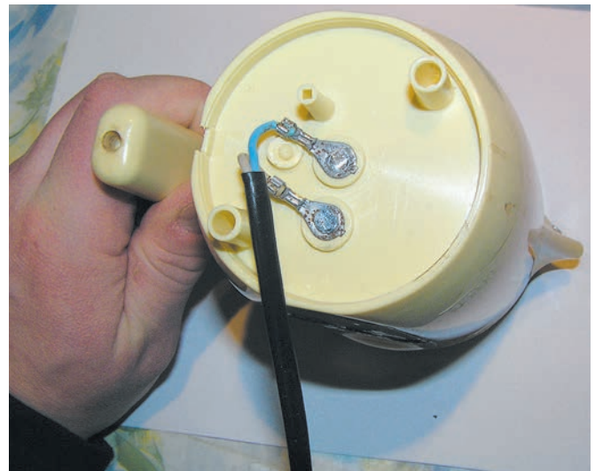
Рис. 3. Подключение проводов электропитания на днище чайника
