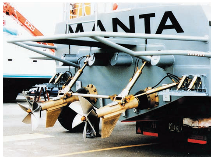
Двухвальный «арнесон». Видны дифференциальные и рулевые гидроцилиндры
