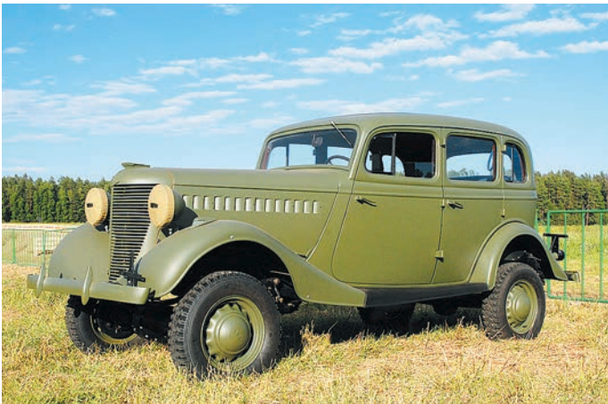
Полноприводной вариант знаменитой «эмки» — армейский легковой автомобиль ГАЗ-61
