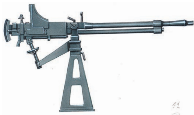
37-мм автоматическая пушка системы Маклена
