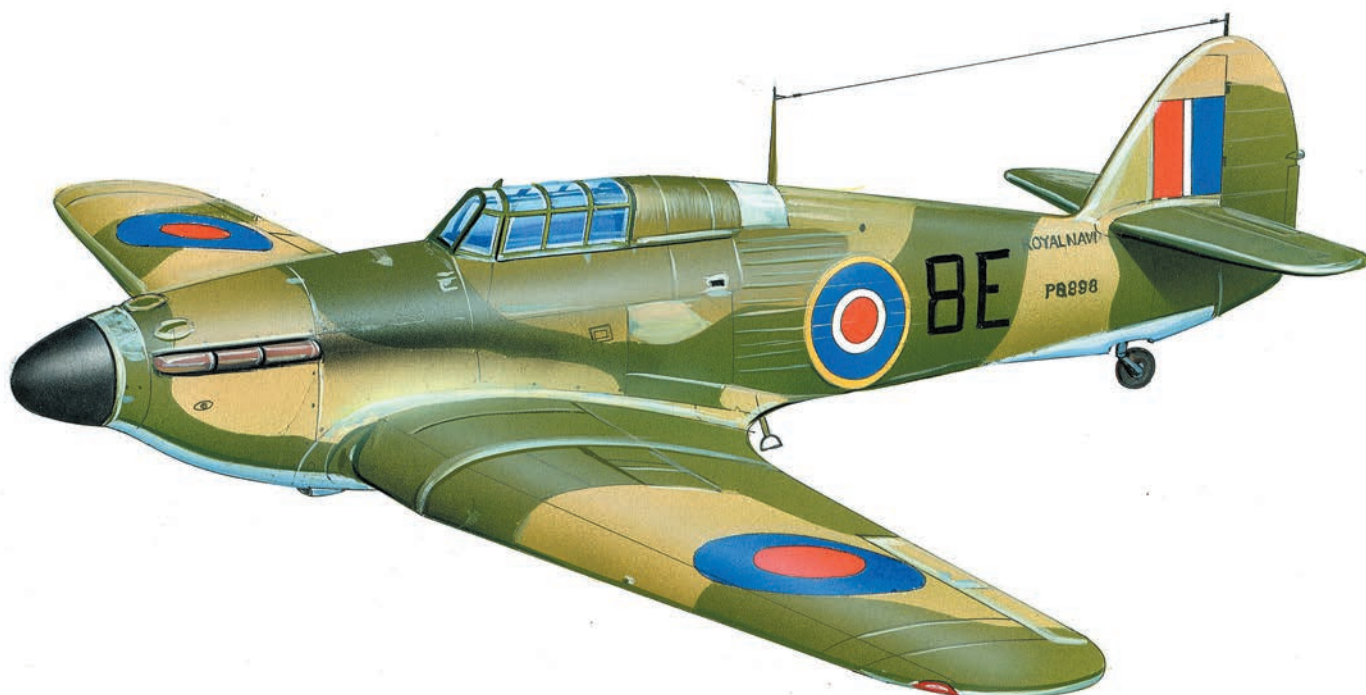
Палубный истребитель «Си Харрикейн» компании «Хаукер» из 760-й эскадрильи Королевского флота с винтом «Ротол». 1942 г.
