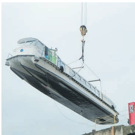
Тримаранные обводы в носу и плоское днище в корме
