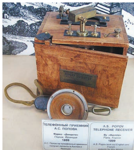
Приёмник Попова для приёма телеграфных сигналов на слух — телефонный приёмник образца 1899 г., выпущенный первым русско-французским радиопредприятием «Rorof-Duckretet», в которое была преобразована фирма «E. Duckretet»
