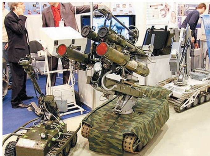
Дистанционно управляемый штурмовой робот МРК-27 БТ
