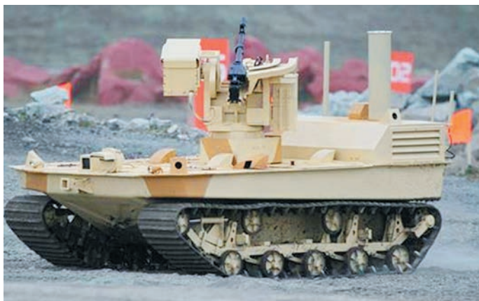
Мобильный робототехнический комплекс МРК-002-БГ-57 управляется по радиоканалу на расстоянии до 5 км
