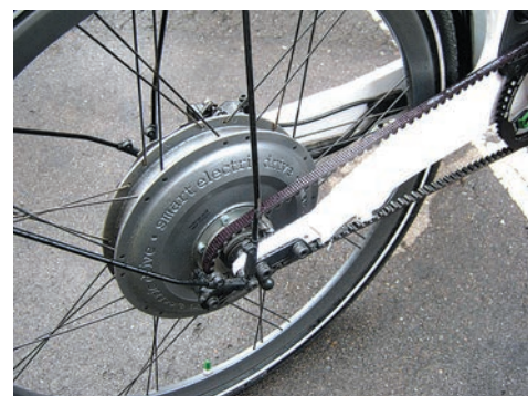
Электромотор во втулке колеса
