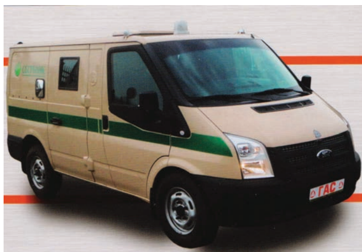
Инкассаторский бронеавтомобиль ГАС-19521 «Клён»: длина — 4863/5680 мм, высота — 2081/2601 мм, ширина — 1974 мм, грузоподъёмность — 850 кг
