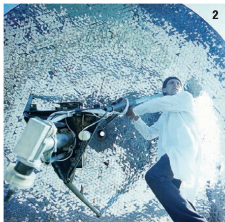
Фото 1. Юстировка гелиостатов — процесс скрупулёзный. Ведь их сотни, и они должны работать синхронно
