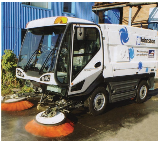
Универсальная уборочная машина 400: вес — 7,5 т, скорость на перегоне — 80 км/ч, при работе — 16 км/ч, длина — 5320 мм, ширина — 1650 мм, высота — 2400 мм
