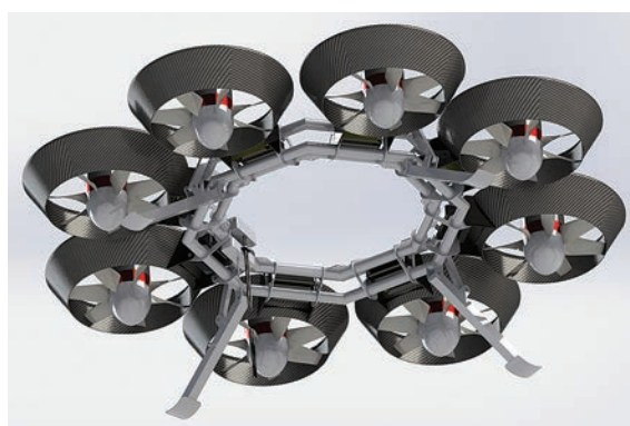
Привязная восьмивентиляторная летающая платформа отечественной фирмы OMV. Получает энергию по кабелю с земли и может находиться в воздухе неделями
