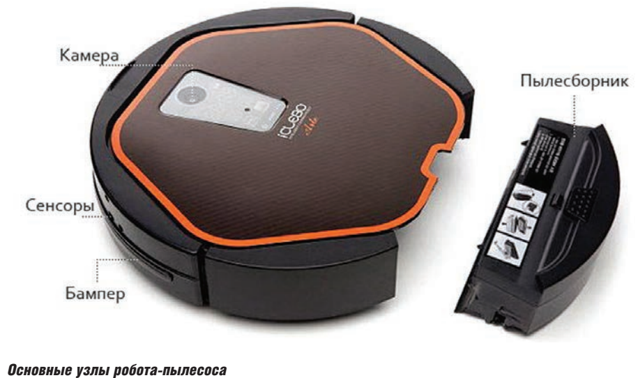
Основные узлы робота-пылесоса
