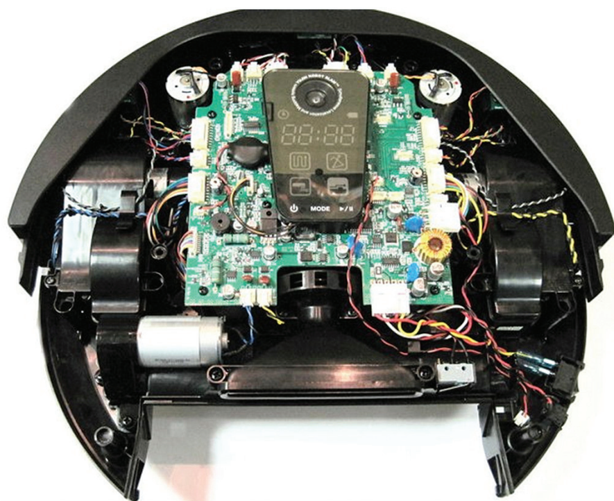
Так выглядит электронная начинка робота. Зелёное — это и есть материнская плата
