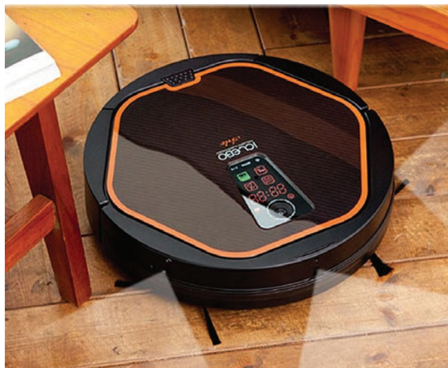
Робот-пылесос приступает к делу. Сверху видна панель, с помощью которой задаются режимы работы
