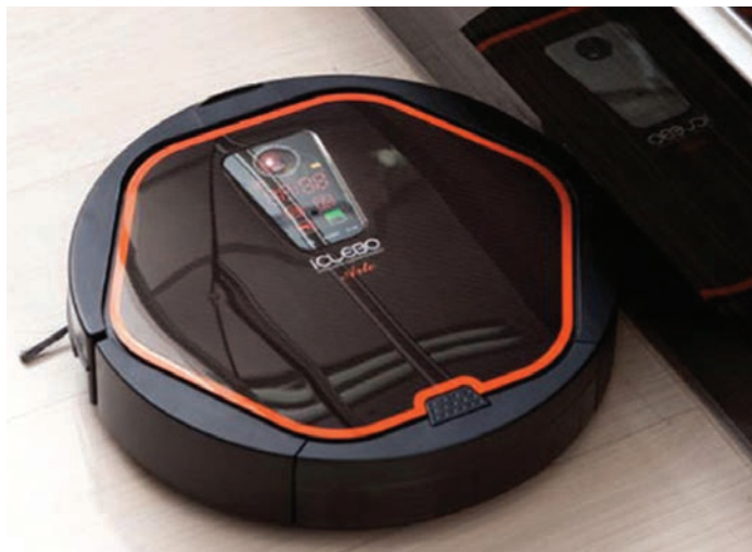
Модель Arte — единственный робот-пылесос на рынке, способный преодолевать порожки высотой до 20 мм. Остальные пасуют, если порожок превышает 10 мм
