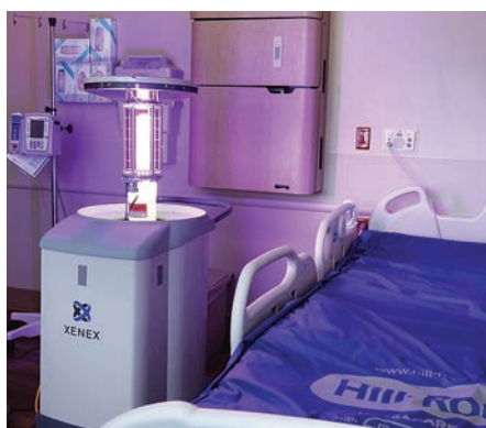
Робот Xenex борется с вирусами кварцевой лампой...
