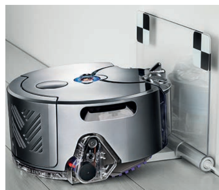
... а робот Dyson 360 Eye — с пылью с помощью «циклона»
