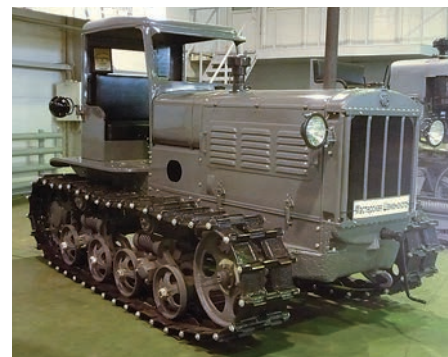
▲ СТЗ-3 — гусеничный трактор средней мощности общего назначения
