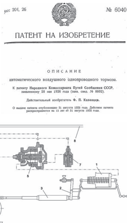
Тормозная система Ф. П. Казанцева: 1 — тормозной цилиндр; 2 — рычажная система; 3 — тяга; 4 — тормозная колодка; 5 — диафрагменный воздухо-распределитель; 6 — ускоритель торможения от запасного резервуара; 7 — регулятор давления; 8 — воздушная магистраль
