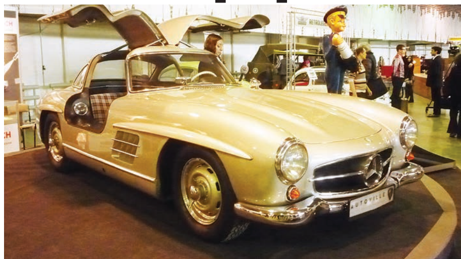
«Мерседес-Бенц 300СЛ», на котором впервые применен впрыск топлива в цилиндры
