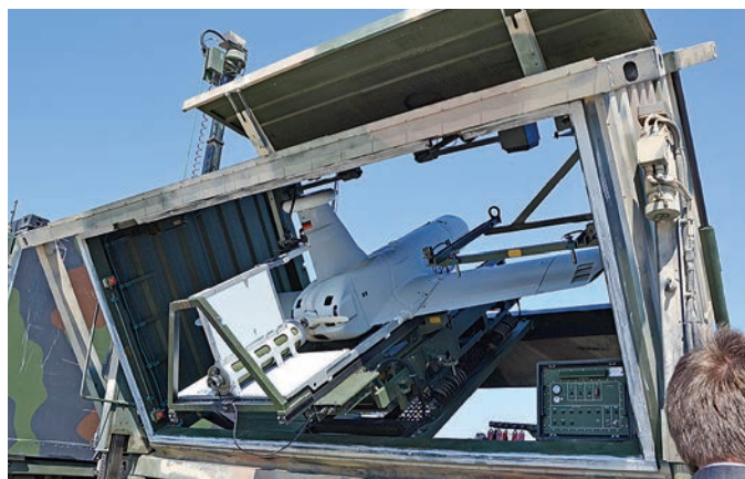
Тактический разведчик/постановщик помех — БЛА KZO компании Rheinmetall DeTec — состоит на вооружении Бундесвера. Аппарат может находиться в воздухе до 6 ч и передавать изображения и видео в реальном времени на расстояние до 150 км
