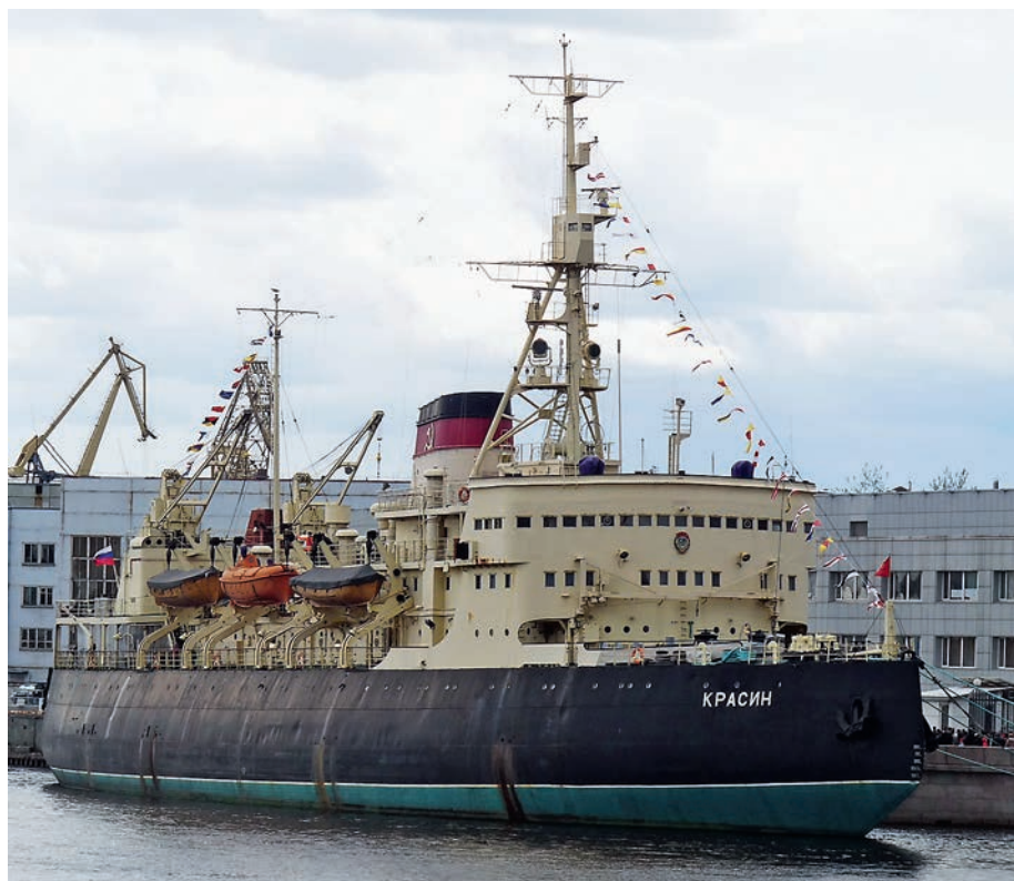
Ледокол «Красин». Место постройки — верфь «В.Г. Армстронг, Митчелл и Ко», г. Ньюкасл, Великобритания. Вошёл в строй в 1917 г. Мощность энергетической установки — 2795 кВт. Водоизмещение (полное) — 8832 т. Длина (наибольшая) — 99,8 м. Ширина (наибольшая) — 21,64 м. Осадка — 7,88 м
