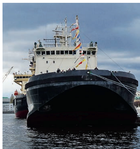
Ледокол «Мудьюг». Место постройки — завод «Вяртсиля», Хельсинки, Финляндия. Вошёл в строй в 1982 г. Мощность энергетической установки — 4х2390 кВт. Водоизмещение (полное) — 8154 т. Длина (наибольшая) — 111,56 м. Ширина (наибольшая) — 22,2 м. Осадка — 6,82 м. Экипаж — 31 человек
