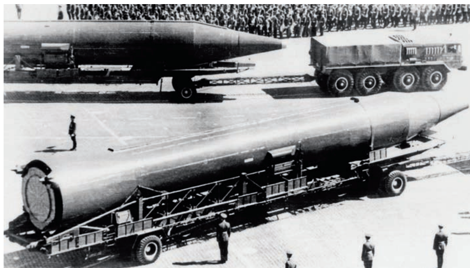
Рис. 6. Слева — Р-12, максимальная дальность стрельбы 2080 км. Самая массовая советская БРСД, количество ракет, стоящих на боевом дежурстве, достигло максимума в 1965 г., составив 693 штуки. Справа — Р-14; в одном из дивизионов с такими ракетами имел честь служить автор этой статьи
