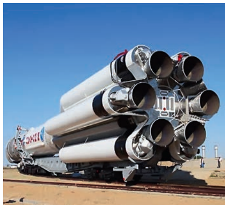
РН «Протон»: двигатели 1-й ступени установлены на «подвесных» баках горючего
