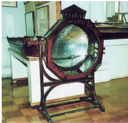
Кулибинский фонарь с зеркальным отражателем
