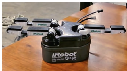
Рис. 6. Кисть компании iRobot с тремя пальцами
