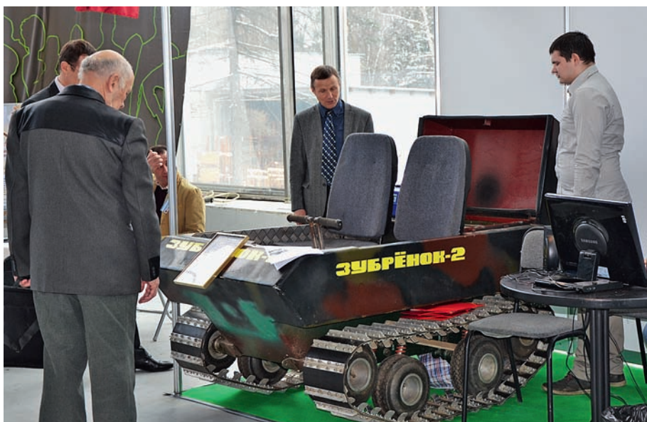
Вездеход «Зубрёнок-2»: вес — 190 кг, скорость на суше — 20 км/ч, на воде — 4 км/ч, мощность двигателя 14 л.с., запас топлива — 10 л, запас хода — 50 км, грузоподъёмность — 200 кг, длина — 1800 мм, ширина — 1002 мм, высота — 1000 мм
