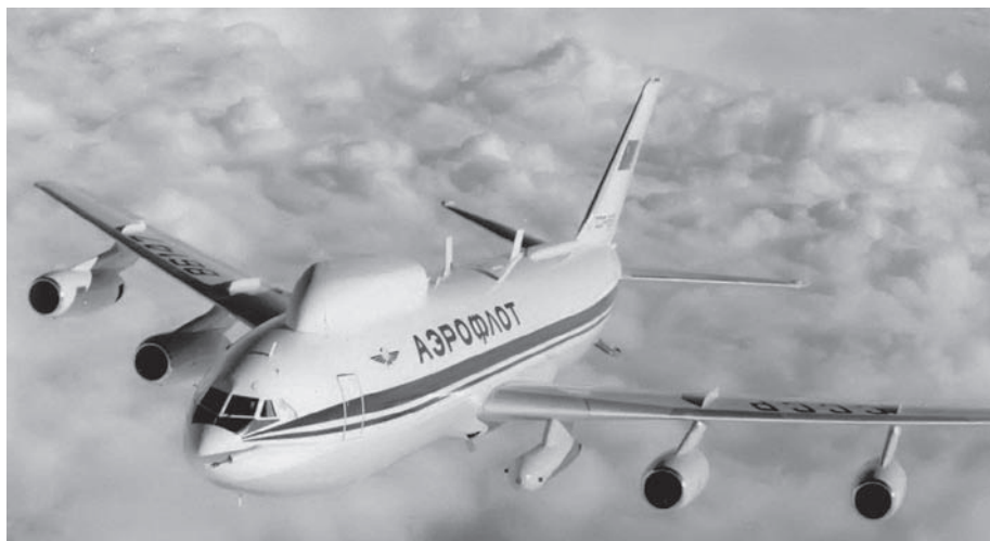
Это не совсем Ил-86. Это Ил-86ВКП — воздушный командный пункт, поступивший на вооружение в 1992 г. Но перегородки на крыльях видны хорошо
