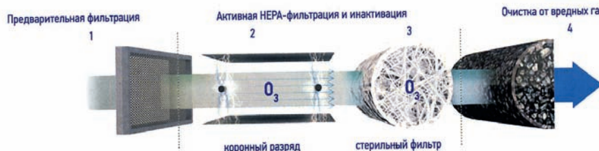
Схема устройства бактерицидного очистителя воздуха ТИОН-А
