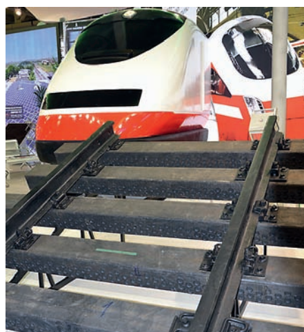
Шпалы из композитных материалов, созданные на предприятии «Твема»
