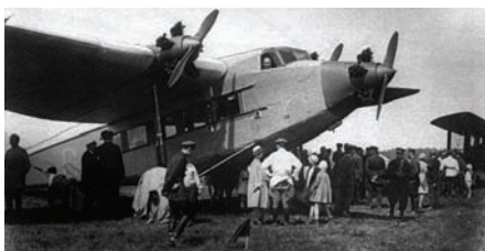
Основной конкурент К-5 — трёхмоторный 9-местный АНТ-9 конструкции А.Н. Туполева
