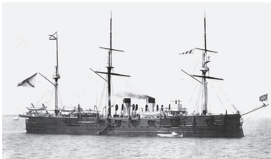
Парусно-паровой фрегат «Минин», строившийся по схеме, подобной «кептеновской», но потом переделанный в нормальный крейсер
