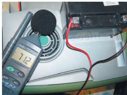
Рис. 7. Практический замер уровня шума вблизи работающего холодильника
