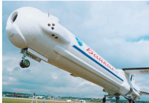
Многоразовый ускоритель «Байкал» на МАКС-2001. Эту машину с крыльями, шасси и турбореактивным двигателем для предпосадочного маневрирования ГКНПЦ им. Хруничева разрабатывал в 1990-х гг. Теперь по такой компоновке делаются ВРБ — возвращаемые ракетные блоки новой системы МРКС
