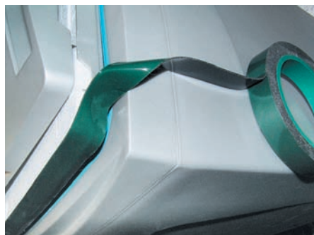
Рис. 8. Прокладка крышки (изнутри) переносного холодильника шумоизоляционной лентой для автомобилей
