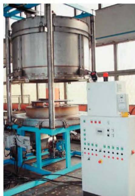
Опытно-промышленный реактор синтеза материала «таунит»
