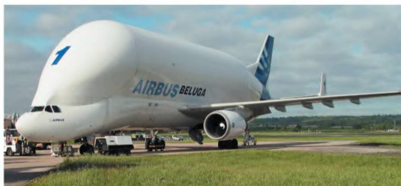
«Белуга» был создан авиакомпанией Airbus для транспортировки собственных же крупногабаритных грузов, а именно – частей для строящихся самолётов
