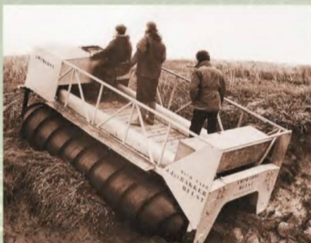
Рис. 1. Шнекоход — это вездеход, движение которого осуществляется посредством шнекороторного движителя.
