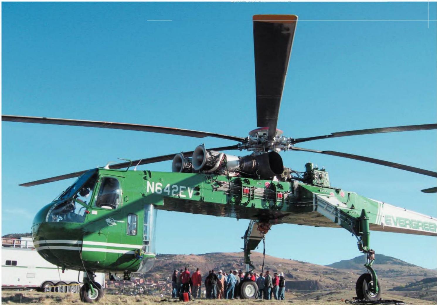
Летающий подъёмный кран Sikorsky S 64 перевозит по воздуху автомобили, самолёты и бульдозеры
