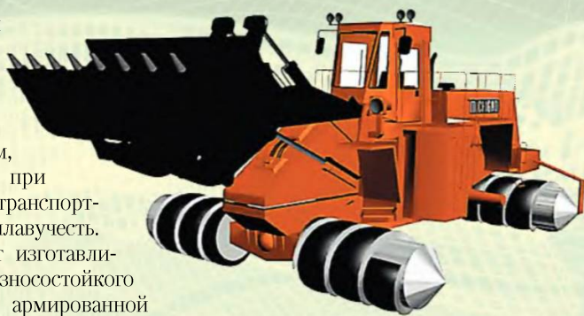
Рис. 6. Разделение ротора на две части позволяет увеличить клиренс и повысить проходимость
