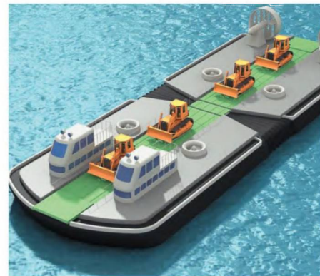
Так будет выглядеть амфибийная платформа «Арктика-60Д» (АВП — 60), предназначенная для перевозки тяжёлых неделимых грузов, колёсной и гусеничной техники, бурового оборудования и строительных материалов по тундре, болотам, большим и малым рекам, в прибрежной полосе морей в течение всего года. Габаритные размеры (м): 15 x 45 x 6,45. Грузоподъёмность: 3 чел. команды и 60000 кг груза +30 пассажиров
