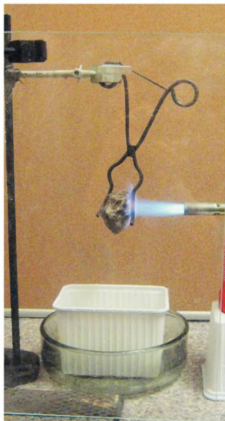
Рис. 2. Установка для экспериментального исследования эффекта Ребиндера
