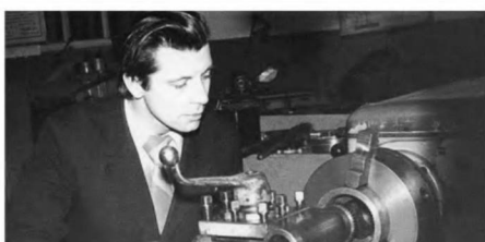
Ю.М. Ермаков с приспособлением для зуботочения на токарном станке мод. 1К62. Станочная лаборатория кафедры «Станки и инструменты» ВЗМИ, позже МГУПИ. Ноябрь 1974 г.
