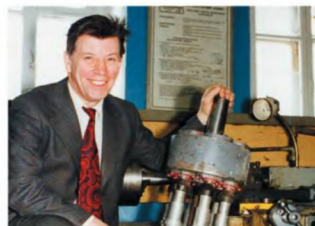
Станочная лаборатория кафедры «Станки и инструменты» МИП, позже МГУПИ. Ю.М. Ермаков со своим изобретением — шестишпиндельным роторным блоком к токарному станку мод. 1К62 (на заднем плане). Май 1996 г.
