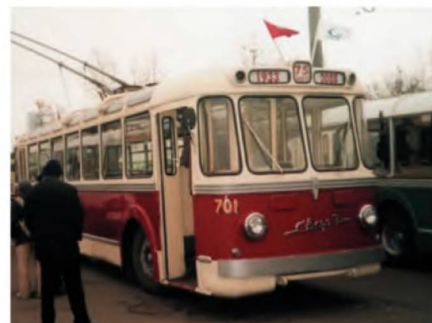
МТБ-ЭС (экскурсионный СВАЗовский), построен в 1961 г. на базе МТБ-82
