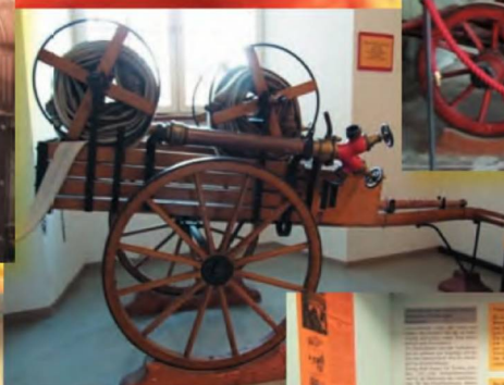
Пожарные рукава и стендер для их подключения к гидранту
