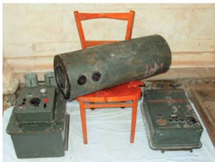
(8) Блоки питания, обеспечивающие применение шестикамерного ЭОПа для астрономических наблюдений. На стуле лежит фокусирующая катушка, слева – высоковольтный блок питания, справа – источник тока
