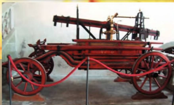
Пожарная насосная установка, приводимым в действие качанием коромысла
