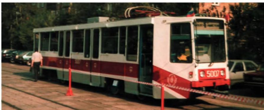
Вагон 71-608 Усть-Катавского вагоностроительного завода с отечественным блоком тиристорно-импульсного управления (в ящике над второй дверью), 1989 г., всего выпущено несколько штук
