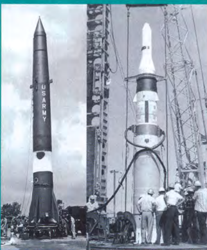
LGM-30B «Минитмен-1». 1 мегатонна на 9200 км, а ракета компактнее, чем оперативно-тактический «Редстоун» (справа)
