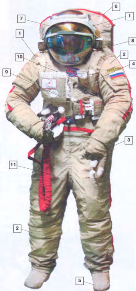
Так выглядит скафандр «Орлан-МК». Цифрами обозначены: 1 — внешняя поверхность скафандра; 2 — рукава и штанины; 3 — съёмные перчатки; 4 — трос для закрывания люка на спине; 5 — ботинки; 6 — ранец системы жизнеобеспечения; 7 — шлем; 8 — устройство «Вальсальва»; 9 — кираса; 10 — кнопки управления; 11 — страховочный карабин
