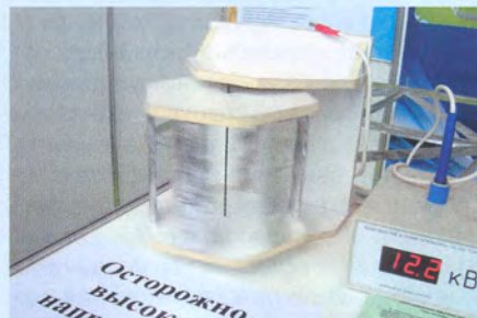
Бесстаторный электродвигатель на эффекте Бифельда – Брауна
