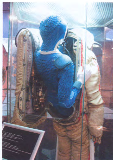
Влезают в скафандр через люк на спине. На крышке этого люка расположена система жизнеобеспечения
