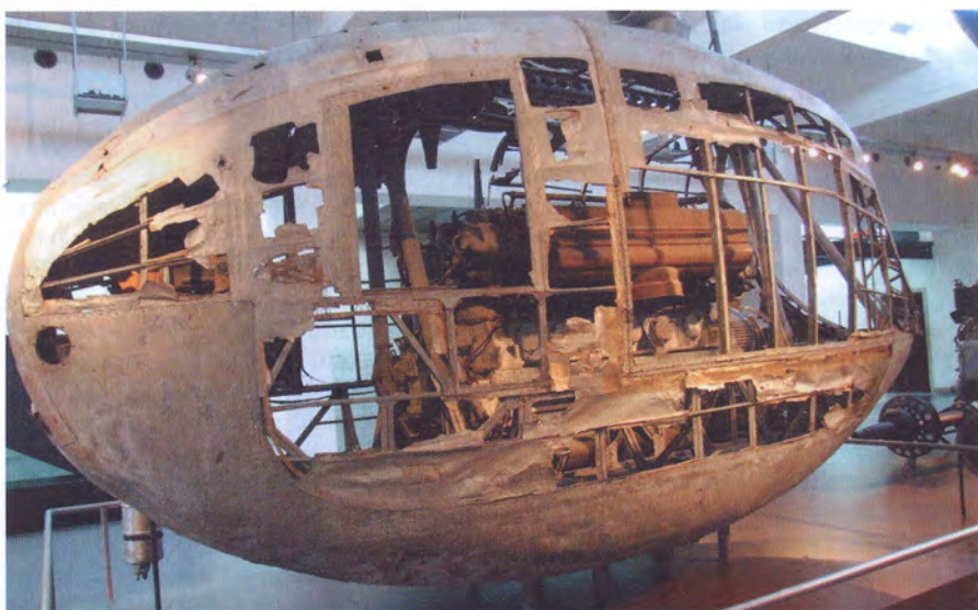
Бортовая гондола LZ 127 «Граф Цеппелин» с двигателем
