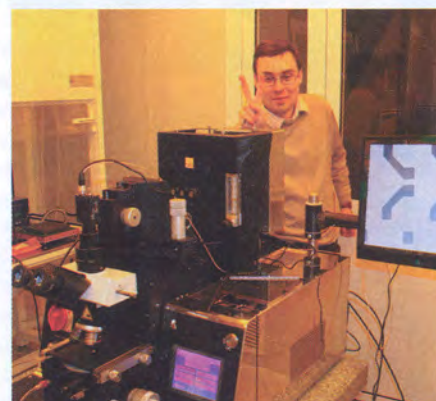
Автор изобретения Вячеслав Муравьёв. На переднем плане: установка фотолитографии для изготовления кристаллов; слева на заднем плане: установка для нанесения фоторезиста — спиннер.
