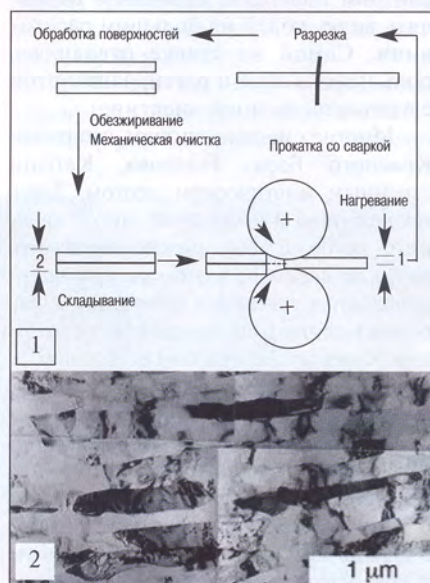
Технологический процесс и его результат: 1 — схема прокатки; 2 — микроструктура алюминия, снятая в электронном микроскопе
