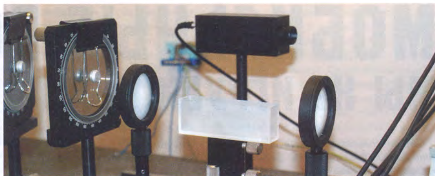
Установка для терагерцевых исследований. Линзы выглядят непрозрачными – так оно и есть, потому что они фокусируют не видимый свет, а волны терагерцевого диапазона.
