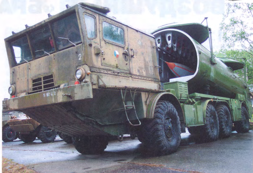
Советский БПЛА Ту-143 «Рейс» поставлялись армиям нескольких стран-союзниц по военному блоку ОВД. На фото — пусковая установка на шасси БАЗ-135МБ (Зил-135К)
