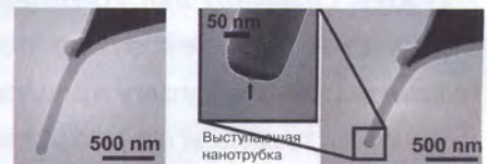
Рис. 1. Нанокарандаш длиной 980 нм (слева); нанокарандаш после заточки - видно, что УНТ выходит на поверхность (справа).
