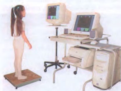
Стабилоплатформа – устройство для определения состояния здоровья по способности человека сохранять равновесие в одной точке
