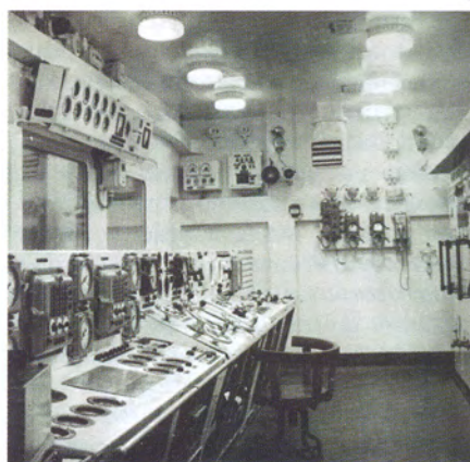
Пост энергетики и живучести (ПЭЖ) «Парижской коммуны» — отсюда управляют работой силовой установки судна
