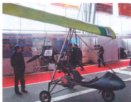
Мотодельтаплан «Поиск-06»: вес пустого – 205 кг, взлётный – 320 кг, диапазон скоростей – 55–120 км/ч, длина разбега и пробега – 200 м
