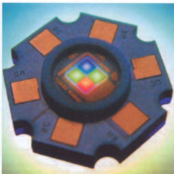
Новое поколение СИД — RGB-диоды. Этот прибор состоит из четырёх отдельных диодов с разными частотами излучения, каждый из которых управляется отдельно (через контактные площадки по периметру прибора) и может плавно менять интенсивность свечения. Таким образом можно получить любой цвет, в том числе и белый. Вверху — заготовка: эпитаксиальная пластина, содержащая десятки тысяч гетероструктур — будущих диодов
