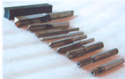
Рис. 10. Инструменты реверсивного резания. Слева направо: токарный резец; двух- и трёхперые свёрла; развёртки
