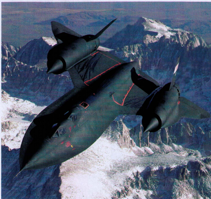
SR-71 – американский стратегический разведчик с крылом треугольной формы
