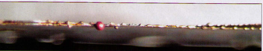
Швы на образце из нержавеющей стали
