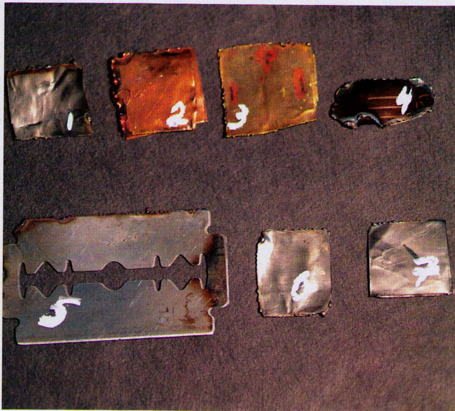
Рис. 2. Образцы сварки разных металлов: 1, 6, 7 – никель; 2 – медь; 3 – латунь; 4, 5 – нержавеющая сталь
