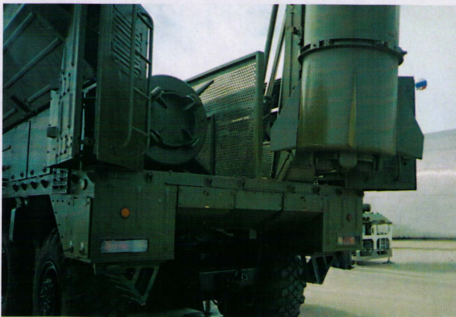
На пусковой установке «Искандера» размещаются две ракеты
