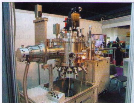
Установка электронно-лучевого напыления высококачественных тонкоплёночных композиций в высоком и сверхвысоком вакууме для НИОКР и пилотного производства. Создана в ЗАО «Научное и технологическое оборудование» (Санкт-Петербург)
