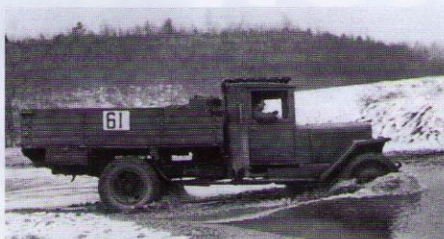
На просёлочной «тряской» дороге газогенератор автомобиля ЗИС-5 «НАМИ» работает даже лучше, чем на шоссе. 1950 г.
