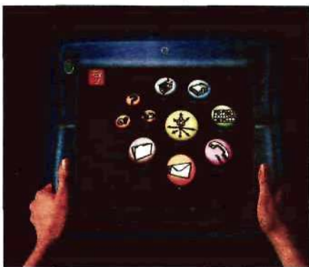
На экран вебпада в наглядной форме выведены основные функции, необходимые для работы в сети, включая телефонную связь и возможность подать сигнал тревоги
