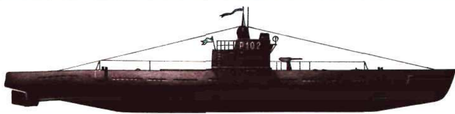
Подводная лодка типа М XV серии: водоизмещение надводное — 281,5 т; подводное — 351,5 т; скорость надводная — 15,8 узлов; подводная — 7,7 узлов; вооружение: четыре 533-мм торпедных аппарата; 45-мм универсальная пушка; мощность дизелей — 1200 л.с.; электромоторов — 460 л.с.; дальность плавания — 2530 миль; глубина погружения — 60 м; длина — 50,5 м; ширина — 4,4 м; осадка — 2,8 м
