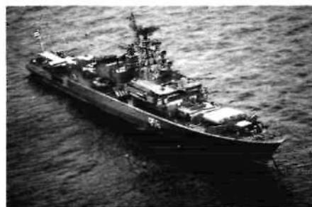
Сторожевой корабль проекта 1135: водоизмещение стандартное — 3000 т, полное — 3400 т, скорость — 33 узла, вооружение: две спаренные артиллерийские установки АК-726 калибром 76 мм, два счетверенных торпедных аппарата для противолодочных торпед, счетверенный ракетно-торпедный комплекс «Раструб», два 12-ствольных бомбомета РБУ-6000, мощность силовой установки — 17000 + 6000 л.с., дальность плавания — до 4600 миль, длина — 123,5 м, ширина — 14 м, осадка — 7 м
