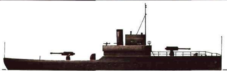
Учебное судно «Московский комсомолец»: водоизмещение — 256 т; скорость — 5,3 узла; вооружение: три 45-мм пушки; 12,7-мм пулемет; мощность силовой установки — 100 л.с.; длина — 41 м; ширина — 6,5 м; осадка — 2,1 м
