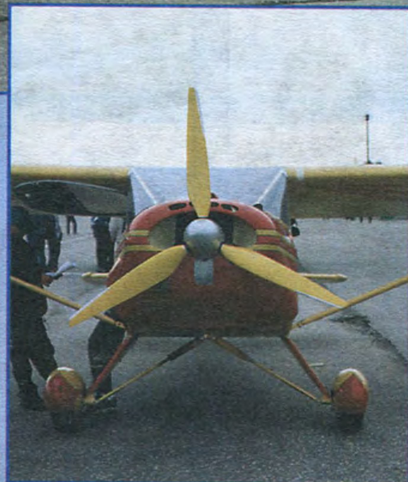
Самодельный высокоплан «Ностальгия»: мощность двигателя — 64 л.с., скорость наибольшая — 150 км/ч, длина разбега и пробега — 120 м.
