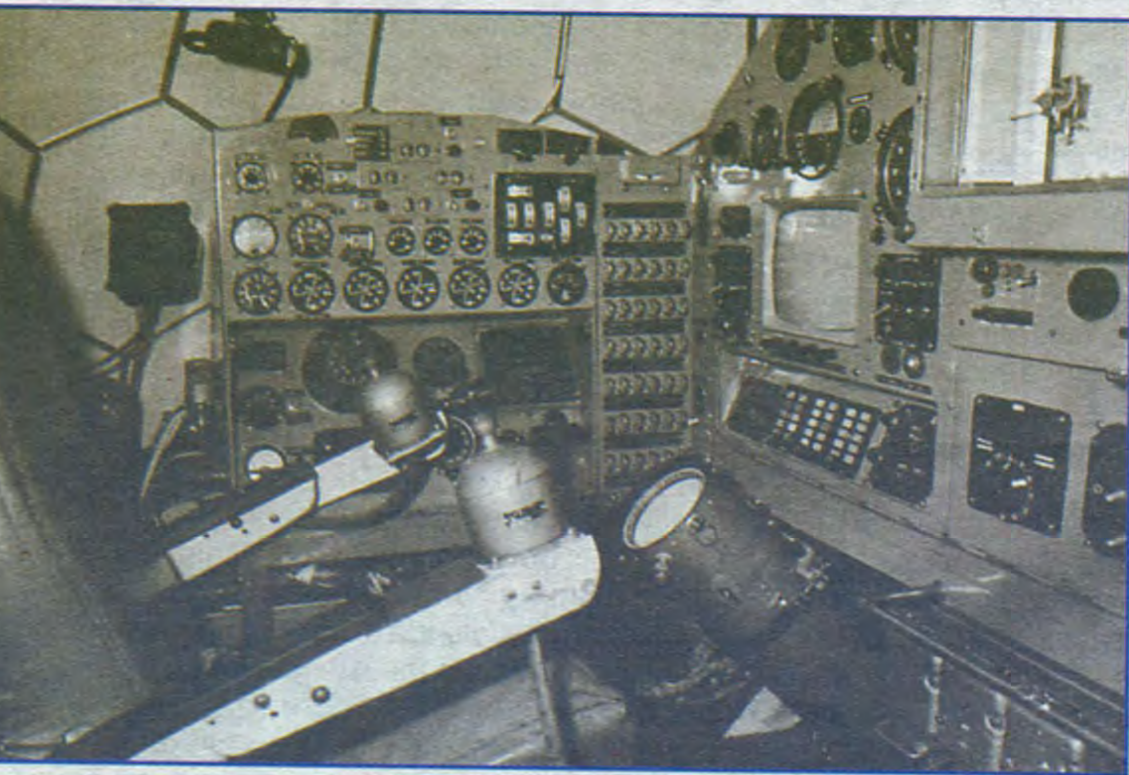
Рабочее место командира в левом кресле. На левом подлокотнике — рукоятка управления движением, на правом — рукоятка управления стабилизацией.
