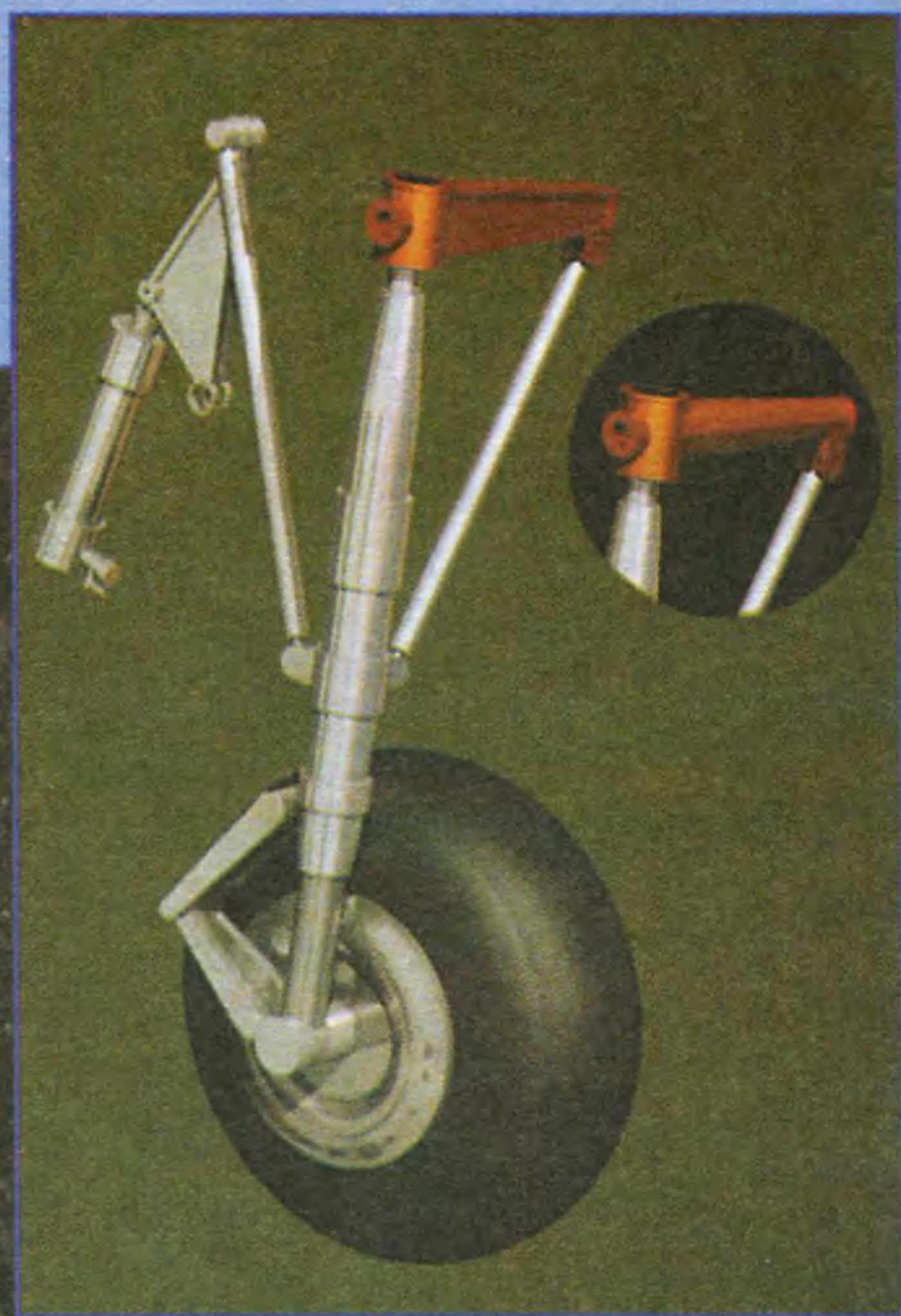
У изначальной модификации Р-38 оси, соединяющие шарниры стоек шасси, были цилиндрическими, а у более поздних модификаций Р-38 и F-5B — прямоугольными и линейными (в увеличенном виде на рисунке справа). Те шарнирные оси, которые обнаружил Ванрель, были линейными.
