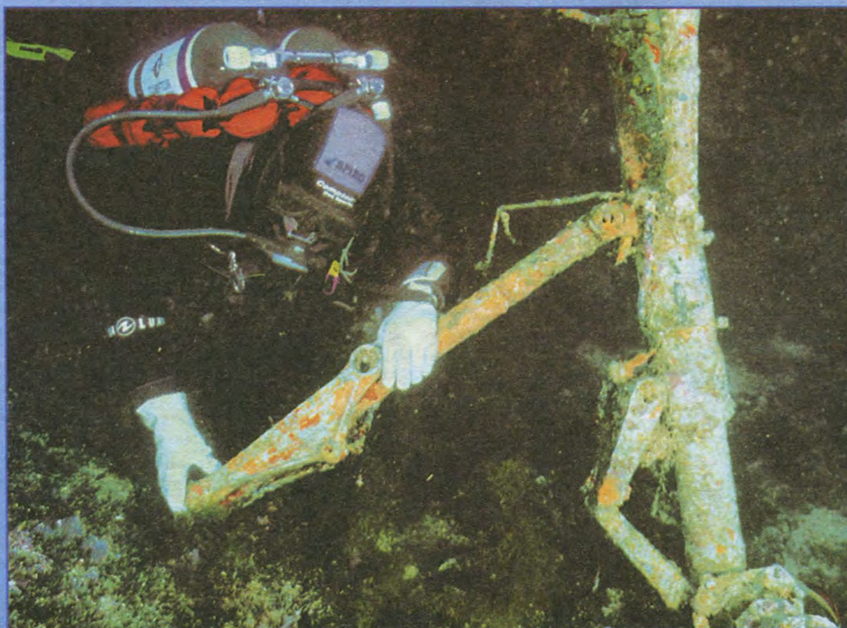
У изначальной модификации Р-38 оси, соединяющие шарниры стоек шасси, были цилиндрическими, а у более поздних модификаций Р-38 и F-5B — прямоугольными и линейными (в увеличенном виде на рисунке справа). Те шарнирные оси, которые обнаружил Ванрель, были линейными.
