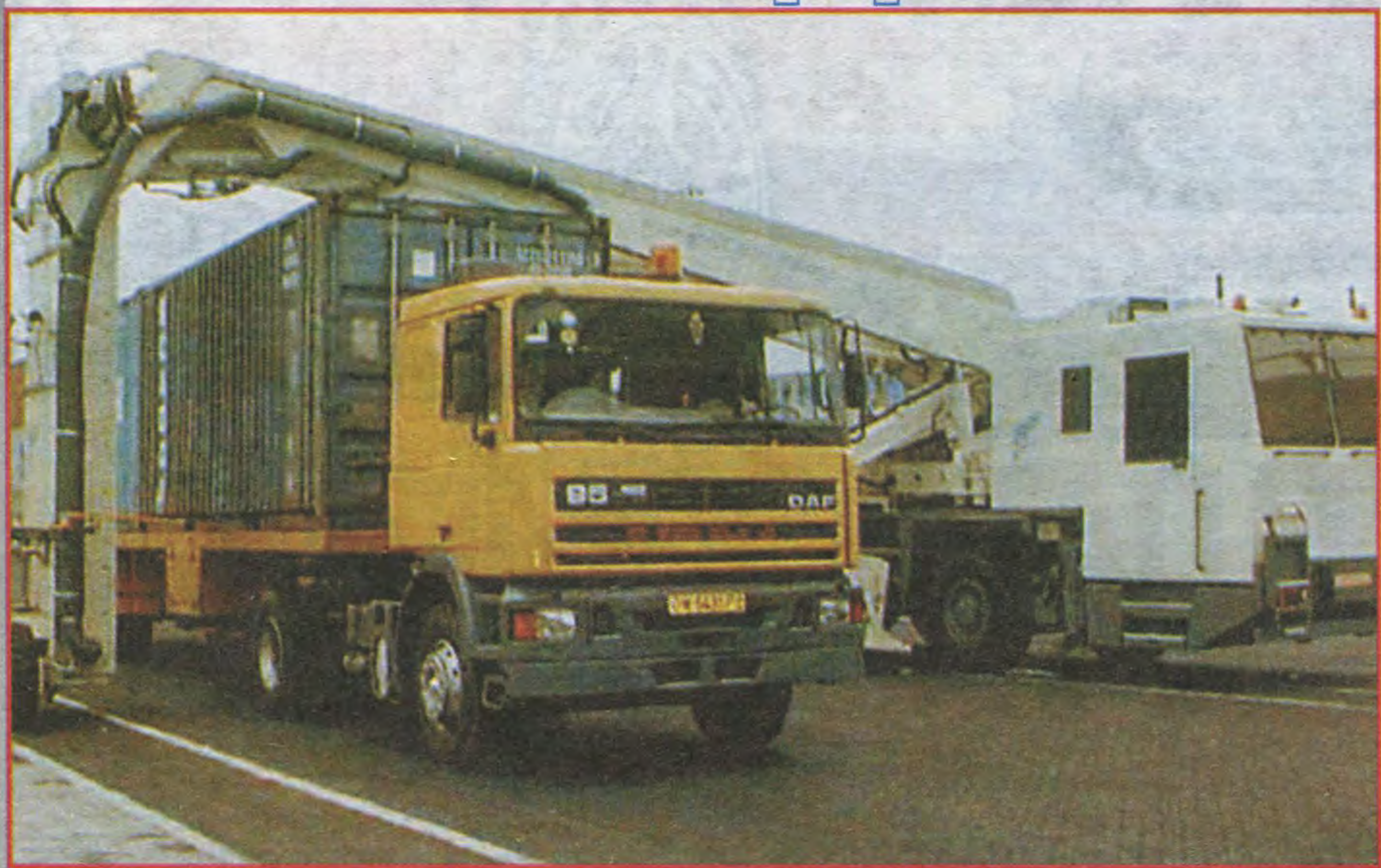
Установка со сканирующей стрелой, охватывающей стоящий трейлер, движется параллельно ему с постоянной скоростью.
