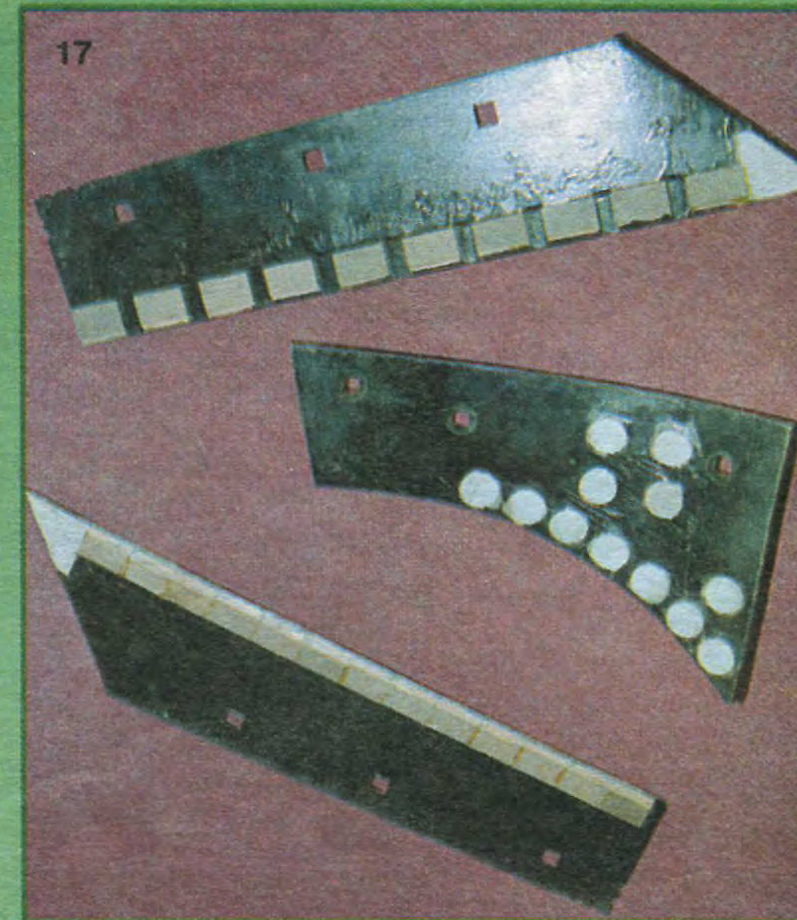
17. Варианты размещения керамических насадок на сельскохозяйственных почвообрабатывающих орудиях.
