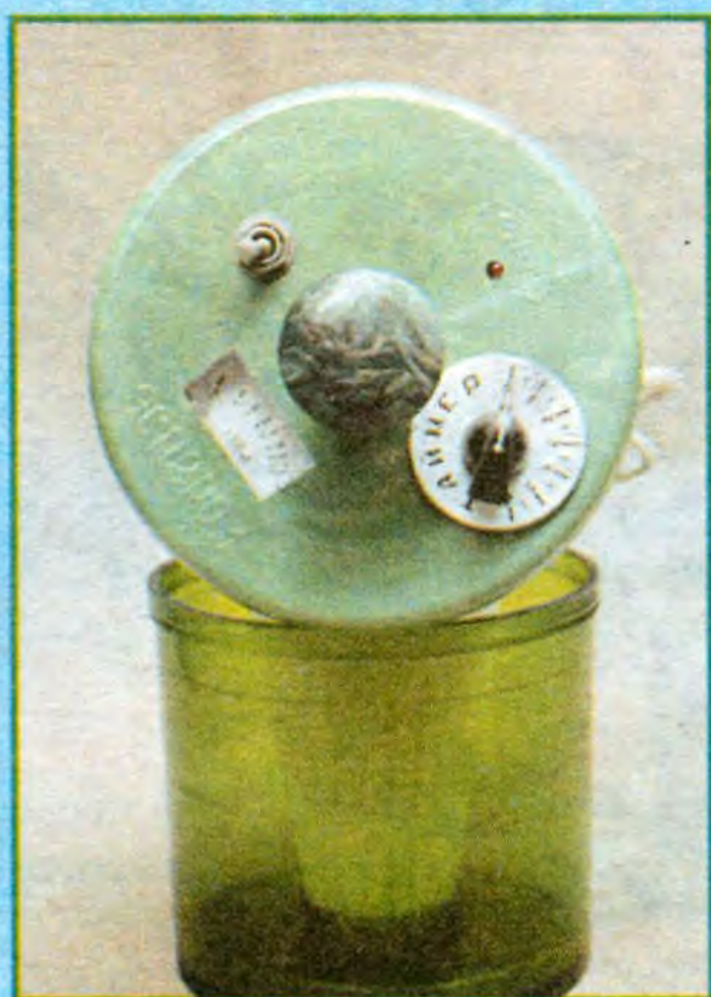
Модифицированный аппарат «Эсперо-2» с таймером и pH-метром.
