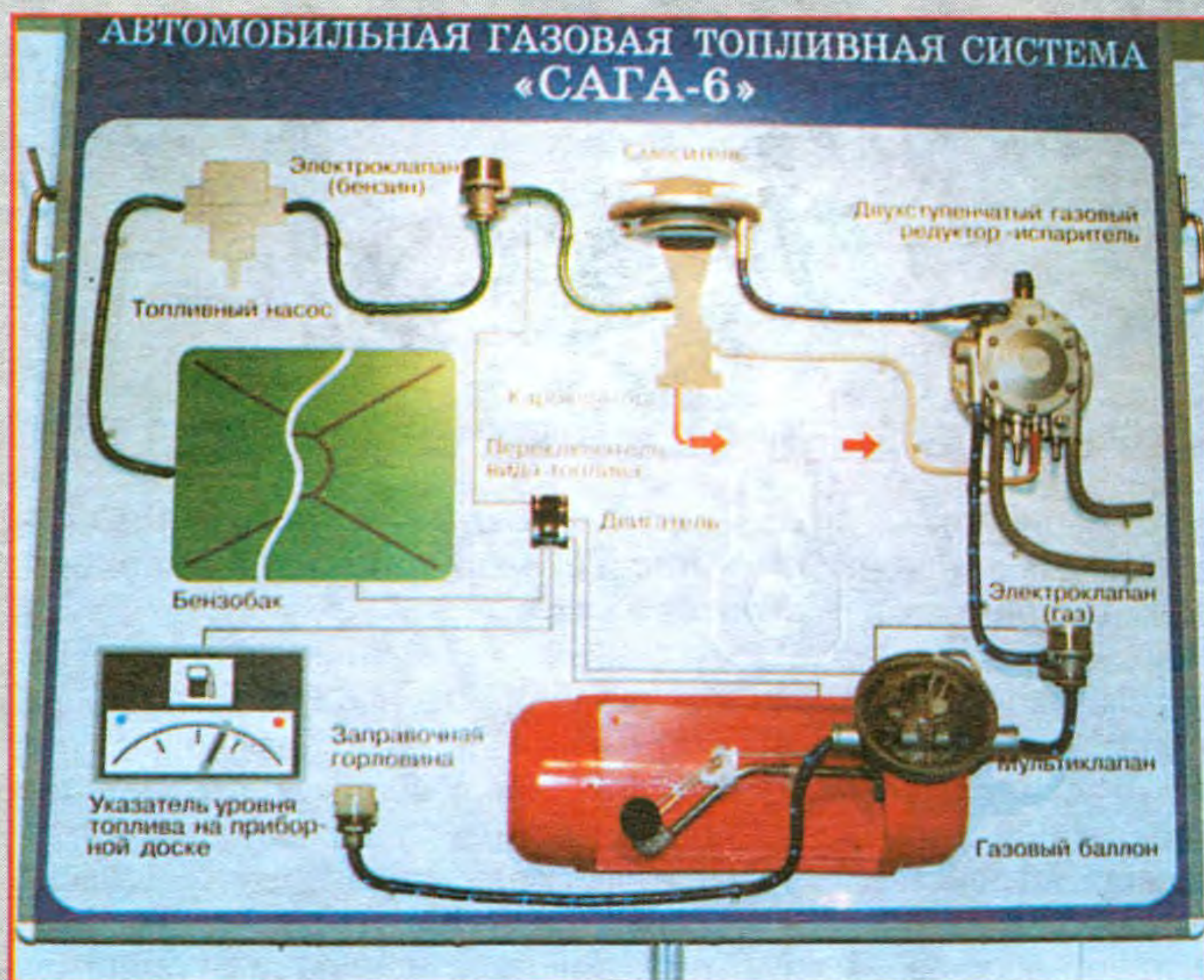
Схема автомобильной газовой топливной системы «САГА-6». ▲
