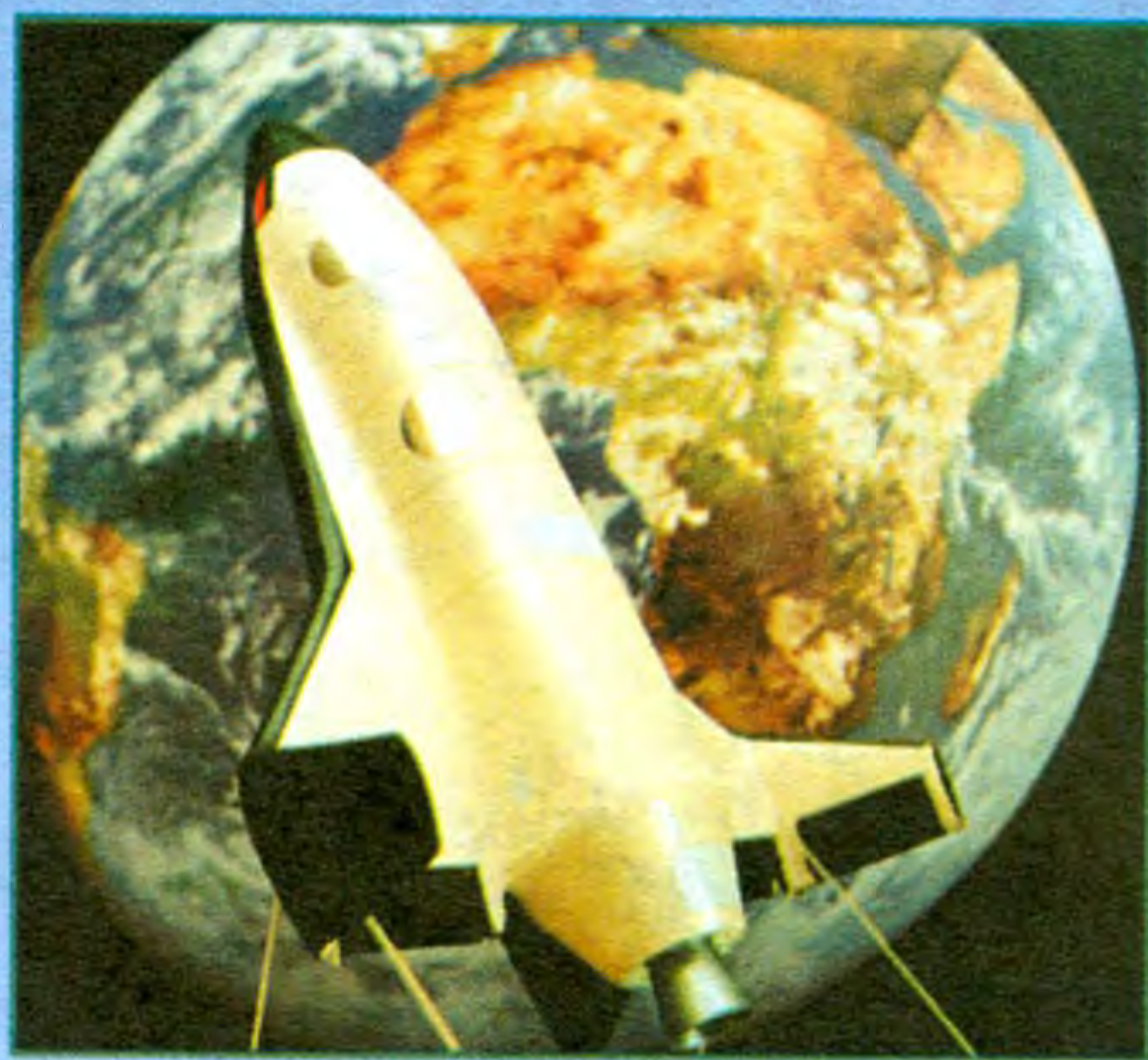
Так выглядит ракетоплан APC: стартовая масса — 1700 кг, длина — 5800 мм, ширина фюзеляжа — 1015 мм, полная ширина — 3700 мм, высота с трехстоечным лыжным шасси — 1500 мм.
