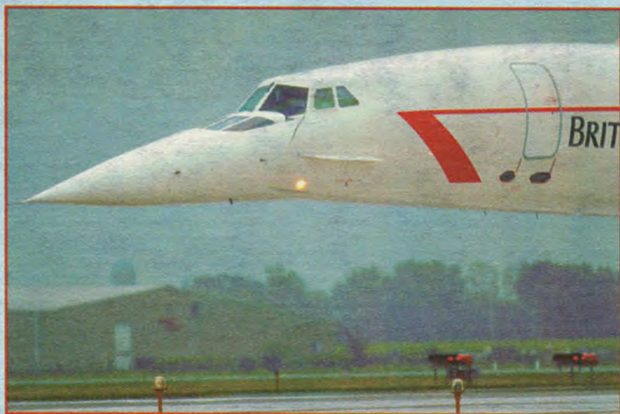
Опускаемый носовой конус «Конкорда» во взлетном положении.
