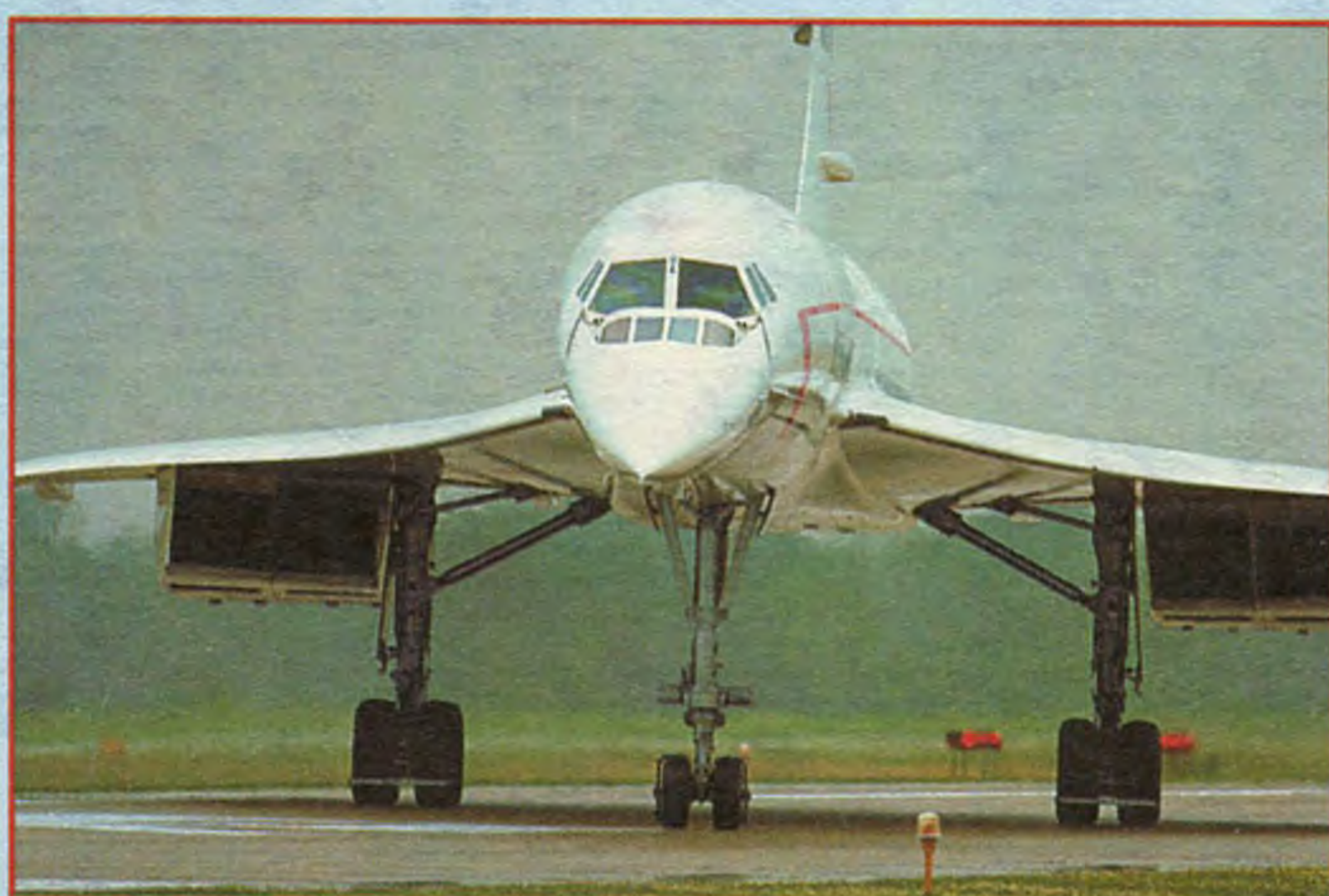
«Конкорд», вид спереди. Хорошо видна конструкция стоек шасси, остекление кабины и воздухозаборники двигателей с регулируемыми створками.
