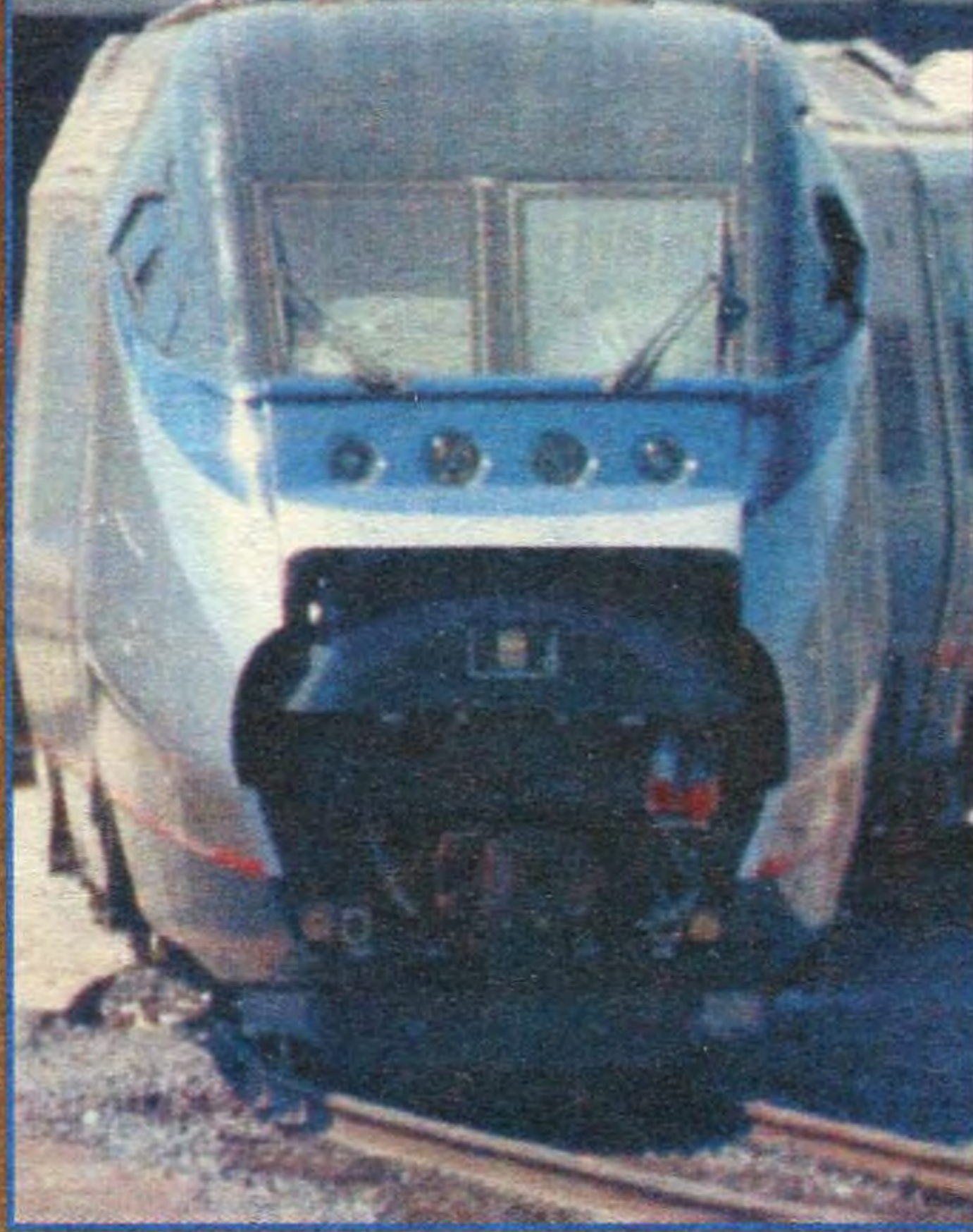
США. Убранный обтекатель открывает автосцепку и придает локомотиву HSGL облик головы хищного насекомого.
