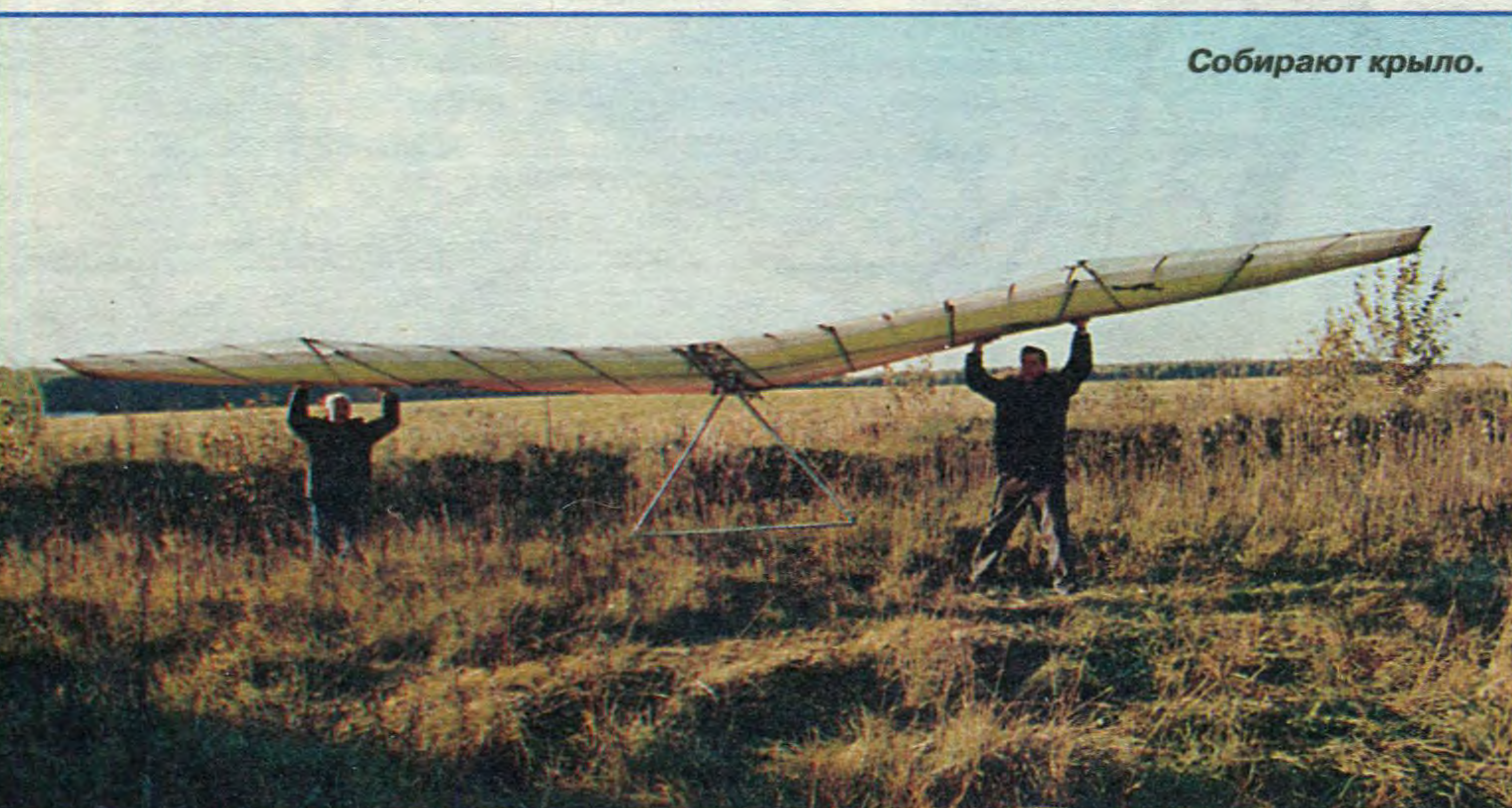
Установка крыла — слева сын автора.
