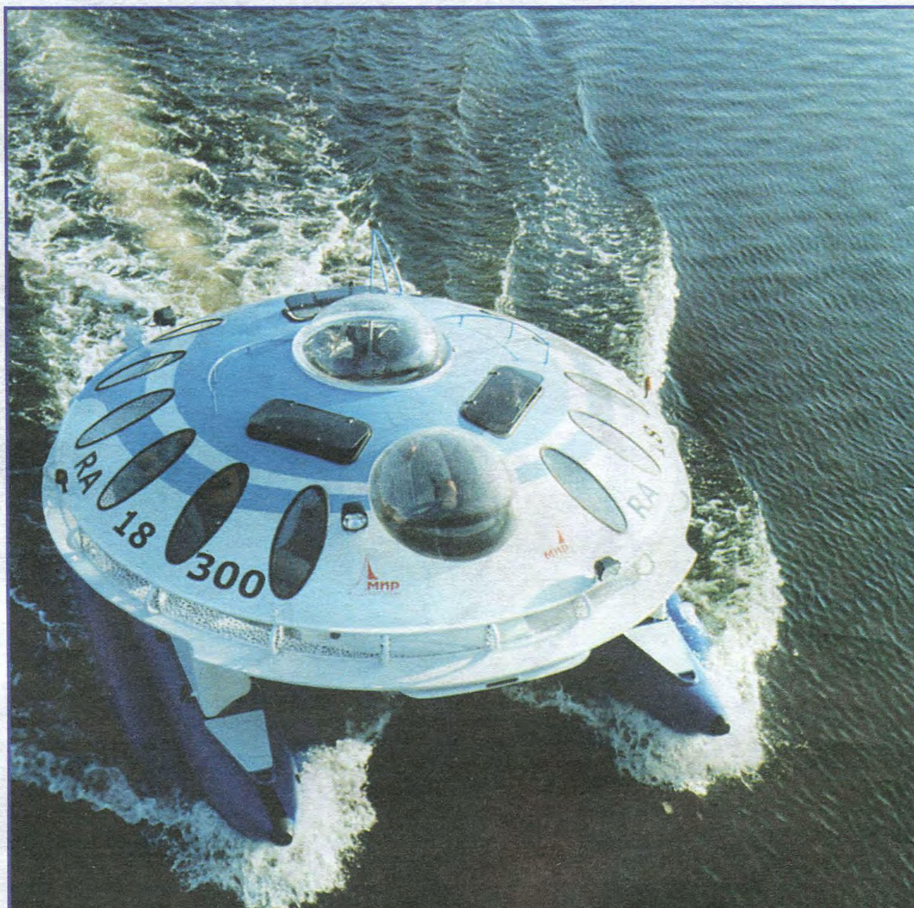
«И-2» на марше. Скорость 25 км/ч с двигателем «Нептун».
