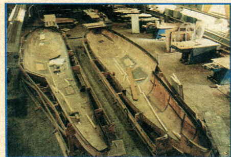
Цех, где из трехслойного стеклопластикового композита формуют корпуса «Амфистаров».
