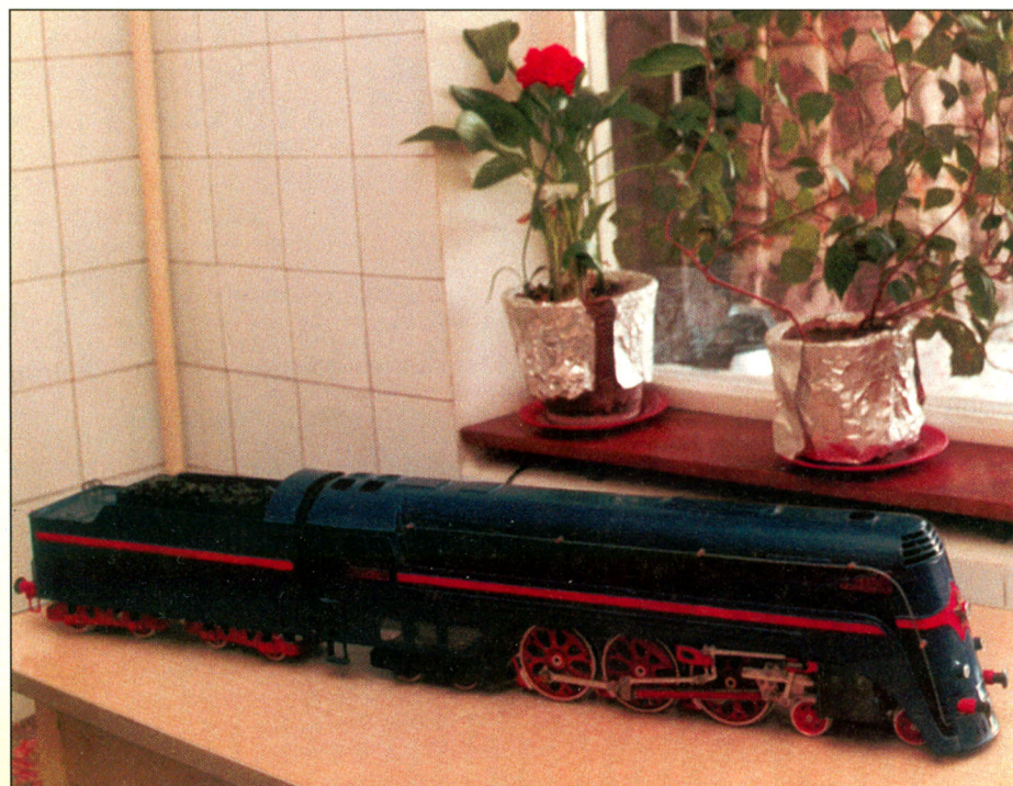
Курьерский паровоз «К» (металл, 1:30, электропривод): год постройки — 1937; колесная формула — 2-3-2; сцепной вес — 64,5 т; мощность — 2000 л.с.; конструкционная скорость — 180 км/ч.
