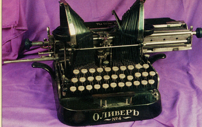
«Оливер», модель 4 (1904 — 1906, США, фирма «Оливер») — с рычажным литероносителем, с верхним расположением двухсекционной системы литерных рычагов (справа и слева от точки печатания). Оттиск производится через красящую ленту ударом литерного рычага по бумагоопорному валу сверху. Строка при работе видна. Машина изобретена в 1881 г. в США священником Оливером. Двенадцать моделей выпущено до 1931 г.
