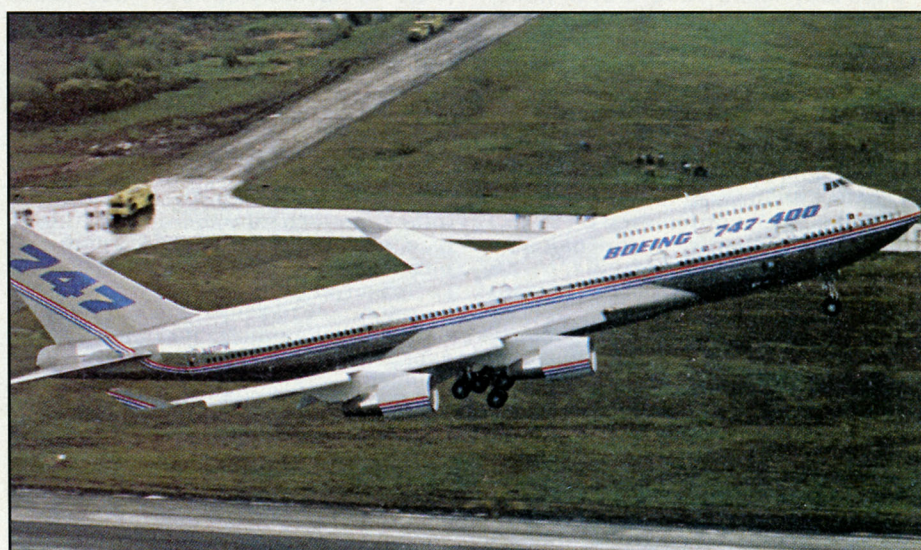
Основные варианты «Боинга-747»: сверху — пассажирский, внизу — грузовой. Всего в США выпустили 800 авиалайнеров этого типа; модель 747-400 рассчитана на 450 — 580 пассажиров.
