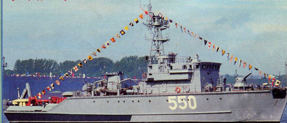
Базовый тральщик проекта 1265 (тип «Яхонт»): водоизмещение — 430 — 460 т; скорость — 14 узлов; вооружение — один спаренная 30-мм пушка, один спаренный 25-мм авто-
