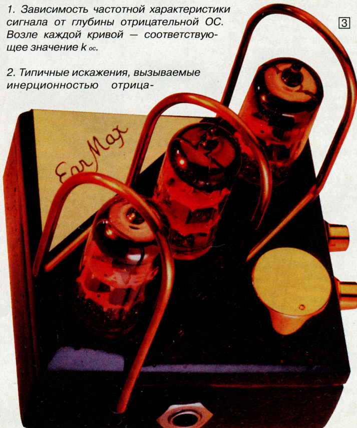
3. Ламповый усилитель EarMax для головных телефонов (Англия). Диапазон частот от 4 Гц до 1 МГц с линейностью \pm 3 дБ. Выходная мощность 0,1 Вт на канал. Рассчитан на наушники с сопротивлением 200 — 2000 Ом. Все разъемы позолочены. Питается от внешнего адаптера. Фирма-производитель гарантирует, что на лицах аудиофилов — пользователей EarMax расцветут улыбки. Цена $520. Улыбайтесь, господа, улыбайтесь!
