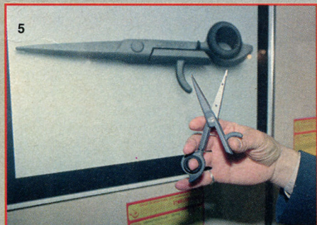
5. Разборные парикмахерские ножницы, представленные французской фирмой «Coiffure creation» легко подгоняются к кисти руки, а сменные лезвия позволяют стричь и филировать волосы одним инструментом.
