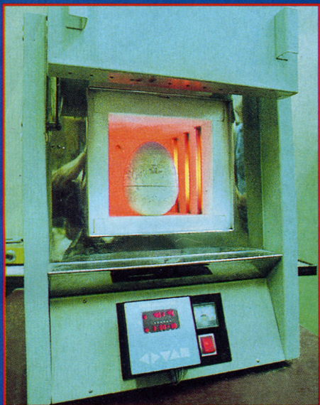
Печь «Бурановка» — нежданная дочь советского Шатла — унаследовала от него термоизолирующую обшивку.
