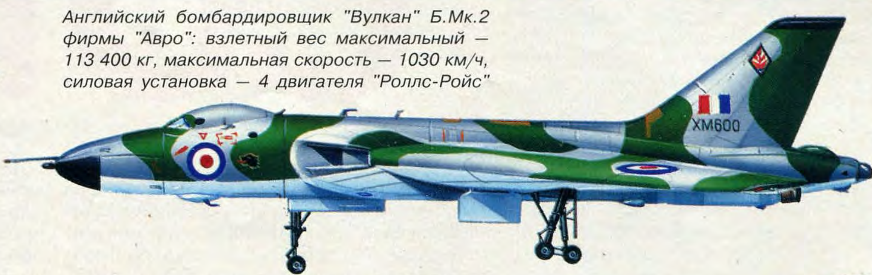
"Олимпус" Мк.301 тягой по 9072 кг, дальность полета — 7400 км, вооружение — до 9526 кг бомб, длина — 31,15 м, размах крыла — 33,83 м, экипаж — 4 — 5 человек.
