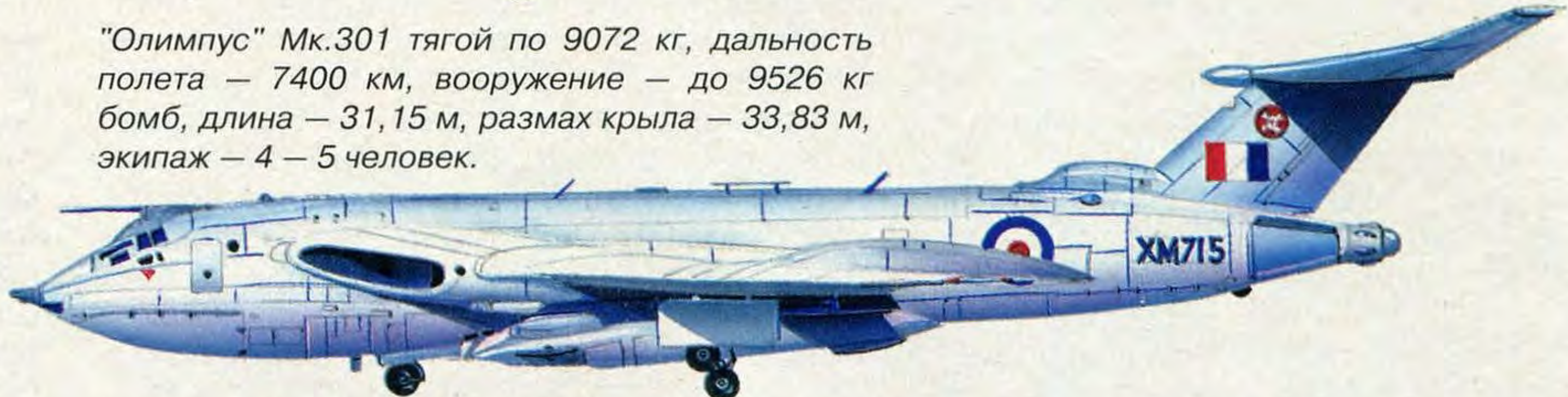
Английский бомбардировщик "Виктор" Б.Мк.2 фирмы "Хейндли-Пейдж": взлетный вес максимальный — 105 689 кг, максимальная скорость — 1030 км/ч, силовая установка — 4 двигателя "Роллс-Ройс" "Конвей" Мк.103 тягой по 7938 кг, дальность полета — 7400 км, вооружение — до 15 876 кг бомб, длина — 35,05 м, размах крыла — 36,58 м, экипаж — 5 человек.
