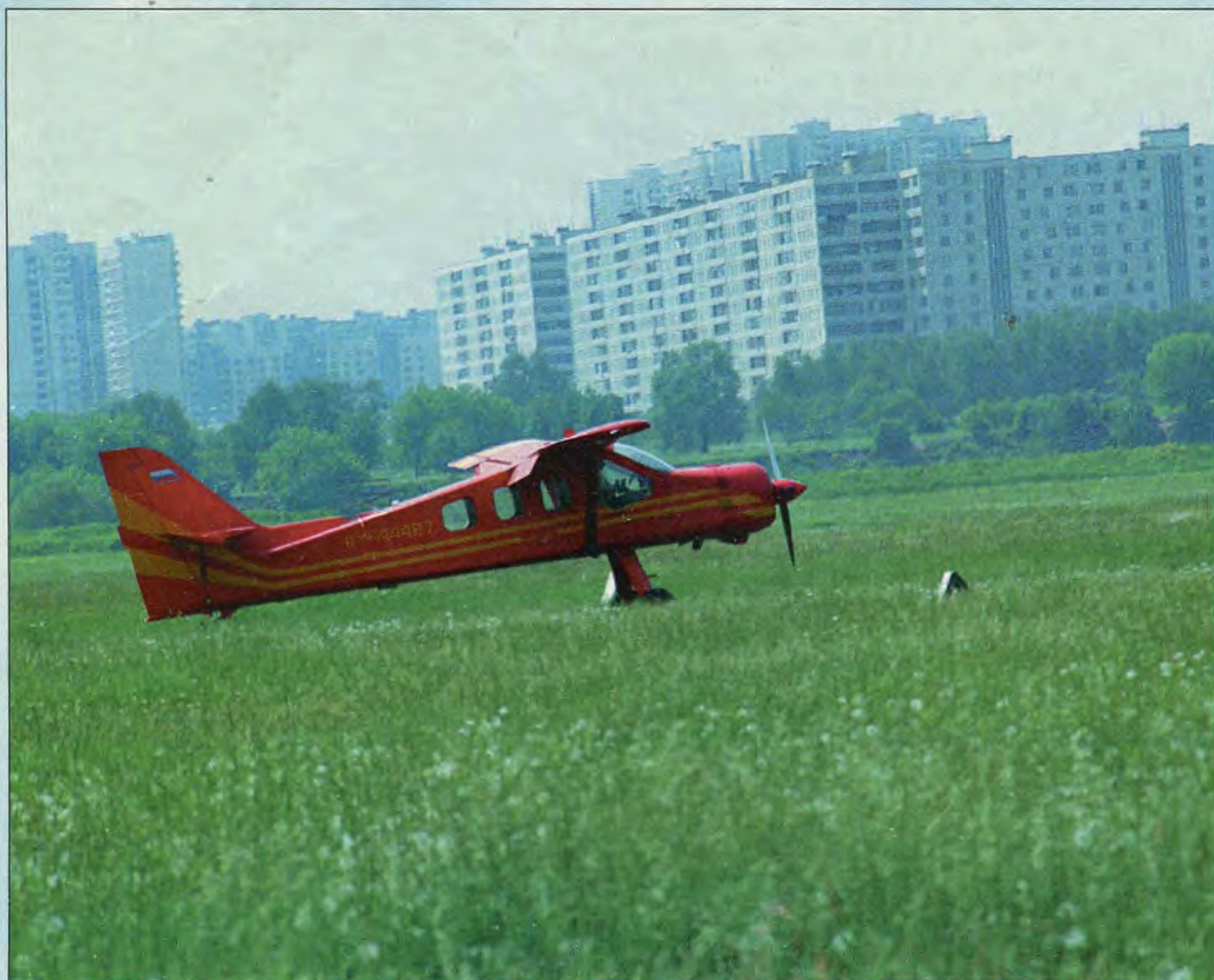
Многоцелевой самолет СМ-91 "Финист": вес пустого — 1500 кг, взлетный вес — 2350 кг, скорость — 200 — 220 км/ч, дальность полета — 1300 км, силовая установка — двигатель М-14Ф, число мест — 1 + 6, полезная нагрузка — 600 кг, длина — 9,1 м, размах крыла — 14,6 м, площадь крыла — 20,4 м 2 .
