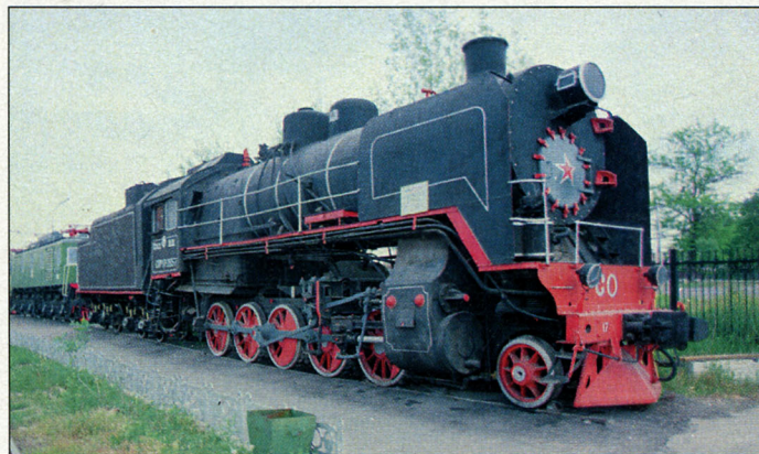
Грузовой паровоз серии СО был разработан в НИИ реконструкции тяги и в Ленинградском институте инженеров железнодорожного транспорта в 1933 — 1934 гг., с 1935 г. началось массовое производство. Сцепной вес 87,6 т, осевая формула 1-5-0, конструкционная скорость 70 км/ч, мощность 1400 л.с.
