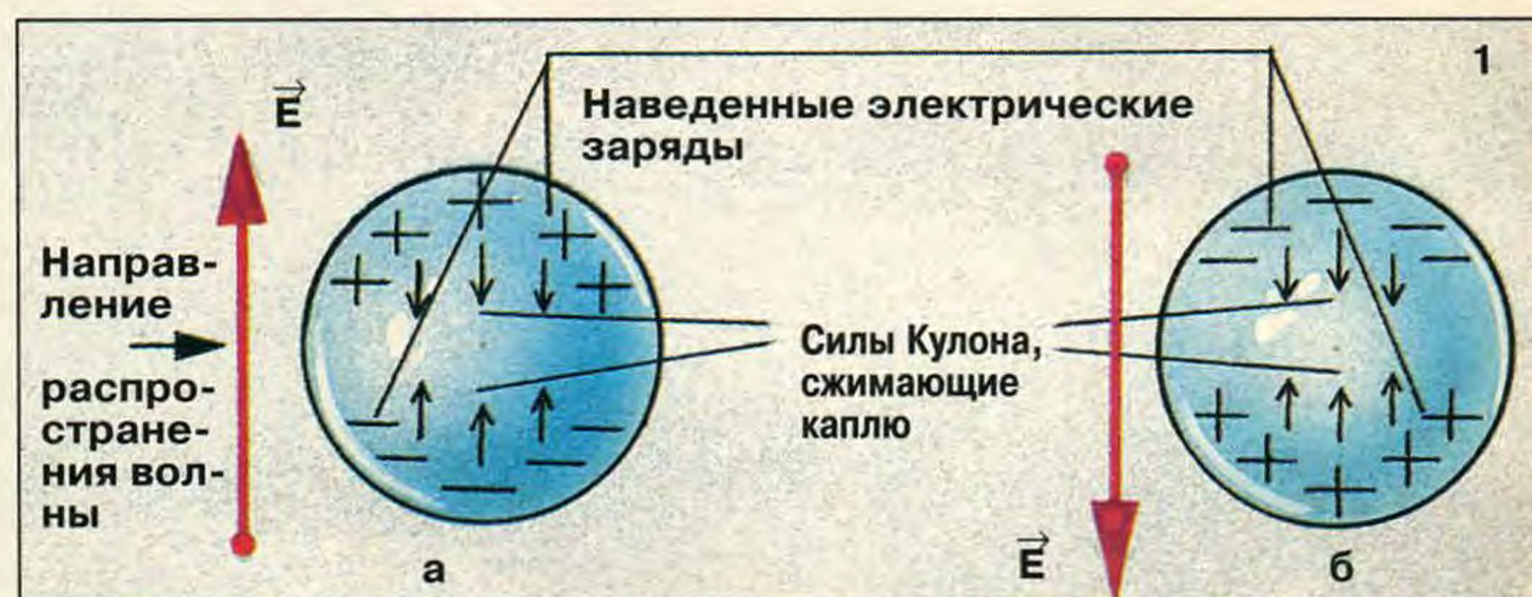
Рис. 1. Электрическая составляющая (E) электромагнитной волны наводит в капле заряды.
