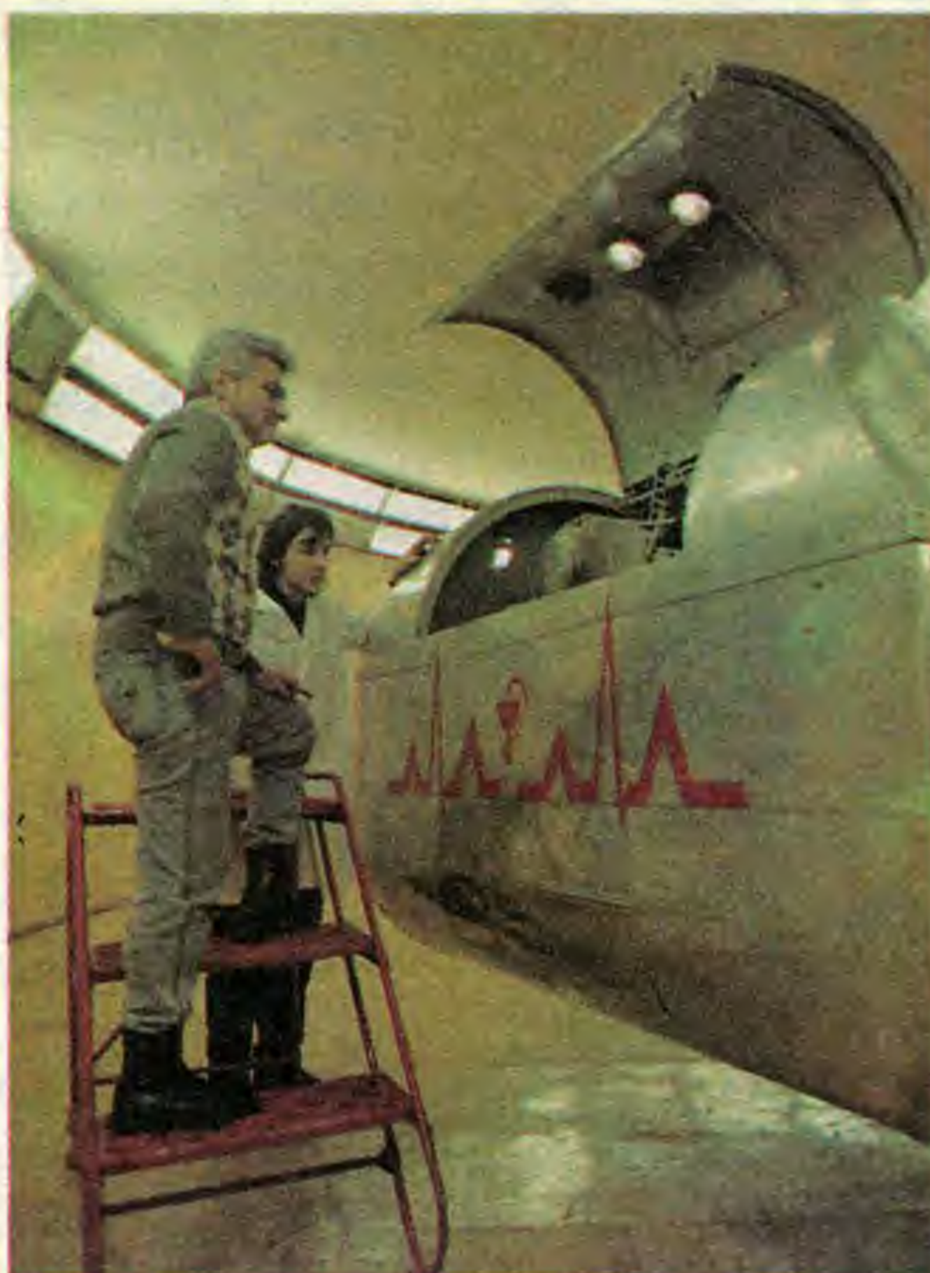
Стенд «Полет» предназначен для выработки устойчивости против укачивания; эксперимент проводят научный сотрудник Григорий Щербаченко и лаборант Элла Петрищева.
