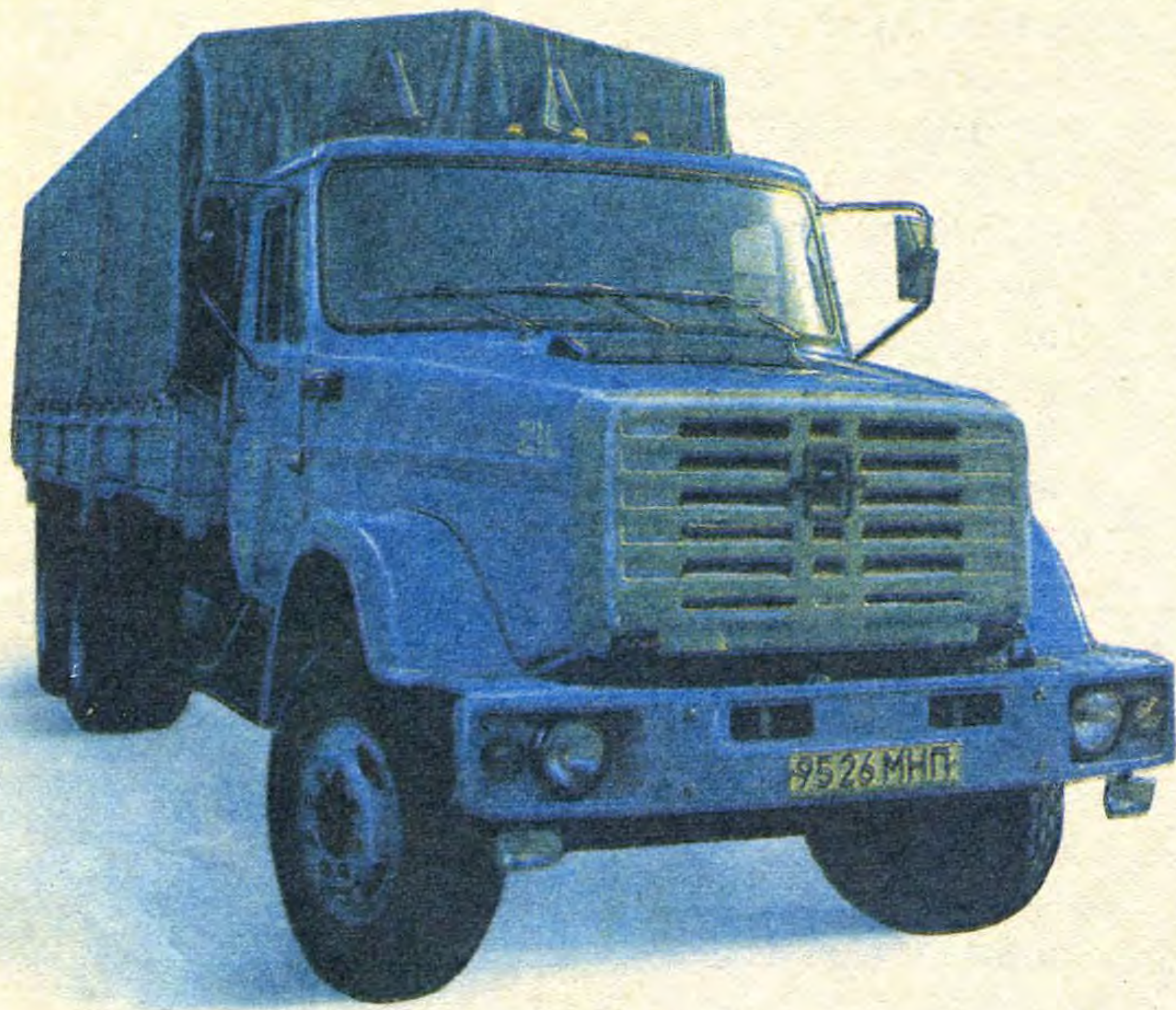
Автомобиль-тягач повышенной проходимости ЗИЛ-131Н4 с дизельным двигателем «CAT 3114» фирмы «Катерпиллер». Мощность двигателя 150 л.с., максимальная скорость — 80 км/ч, расход топлива на 100 км пути (при скорости 60 км/ч) — 25 л. Масса снаряженного автомобиля — 6705 кг, перевозимого груза — 5 т (по бездорожью — 3,75 т). Имеет 3 ведущих моста; предназначен для грузоперевозок по дорогам без твердого покрытия и может быть оборудован ремонтной мастерской, буровой установкой, цистерной, фургоном.
