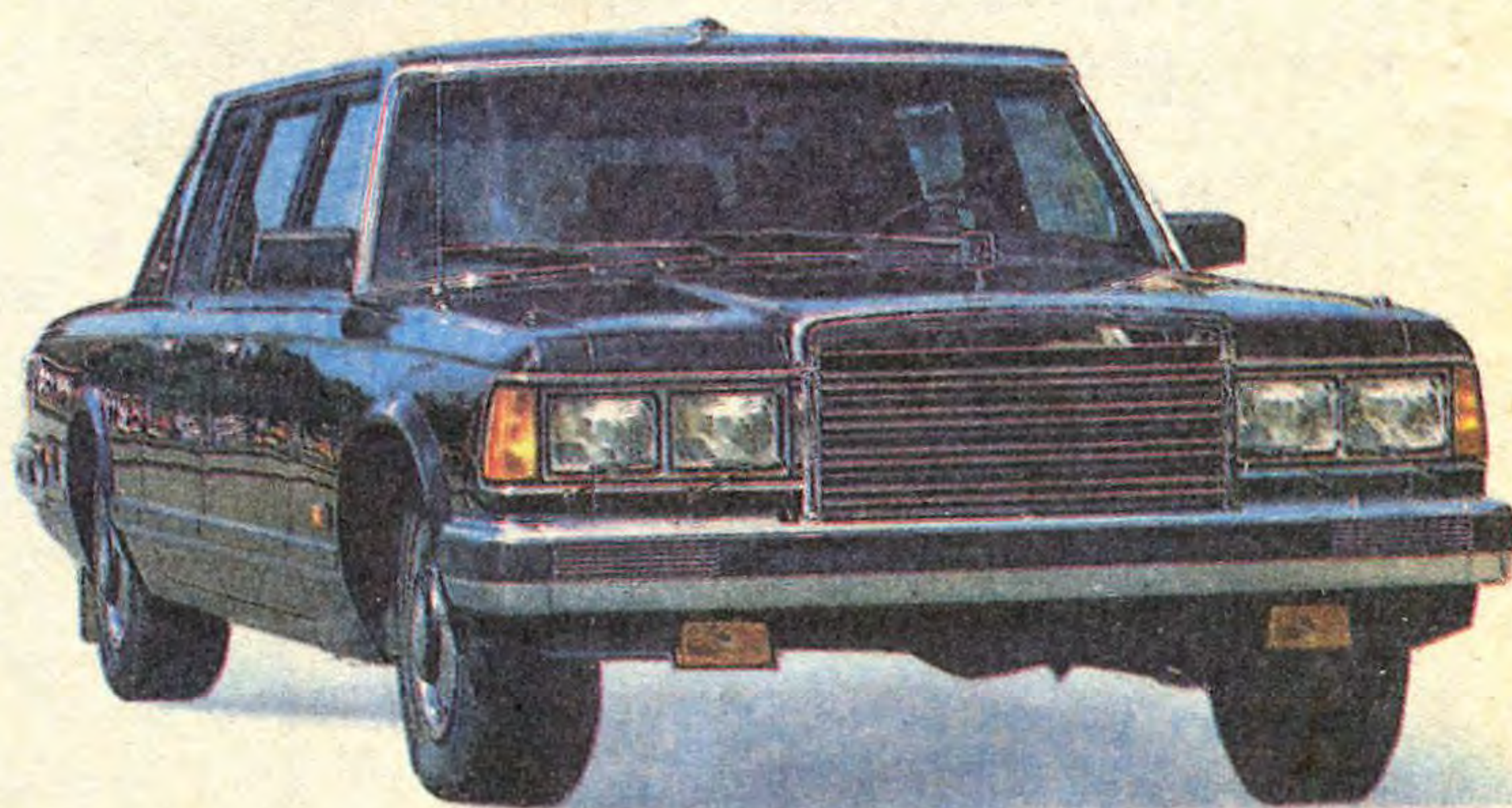
Легковой автомобиль репрезентативного класса ЗИЛ-41047, используемый в официальных поездках президента и премьер-министра России. Полная масса — 3860 кг, скорость — 190 км/ч, число мест (с откидными сиденьями) — 7. Оборудован системами безопасности, кондиционерами, устройствами спецсвязи.
